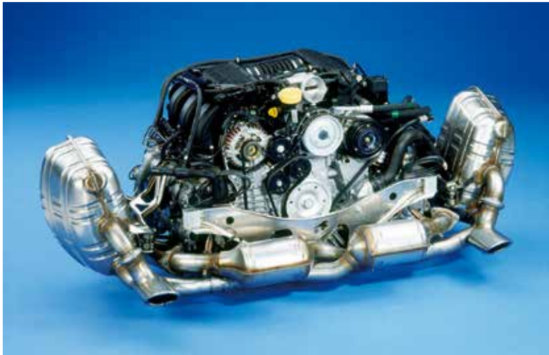
911 カレラ (タイプ996) の3.4に搭載される3.4L水平対向6気筒エンジン。ボクスターの2.5Lと基本設計を共有する。最後の空冷モデルである911(タイプ993)が3.6Lの排気量から272psを発生したのに対し、新しい水冷ユニットは200cc少ない排気量にもかかわらず300psのパワーを発揮した。911の未来を切り拓く切り札となるエンジンだった。
