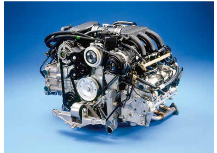
986型ボクスターの2.5L DOHC 24バルブの水平対向6気筒エンジン。ボアストローク85.5mm×72.0mmとなる2480ccエンジンは、204ps(150kW)/6000rpmの最高出力と245Nm(25.0kgm)/4500rpmの最大トルクを生み出す。ブロックとシリンダーヘッドはアルミ製である。この写真は1997年に撮影したもの。
