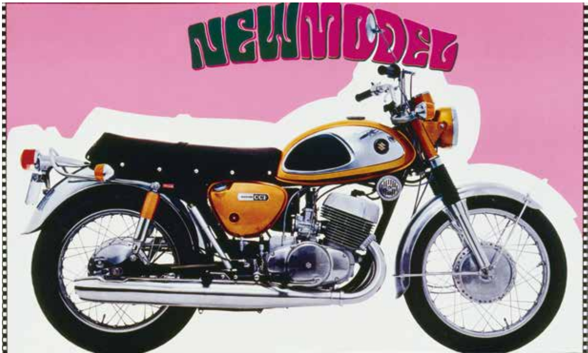
T500のポスター。2ストローク最大排気量を誇る、重量車の風格を醸し出している。エンジンは、空冷2ストローク2気筒492ccで最高出力は47ps。
