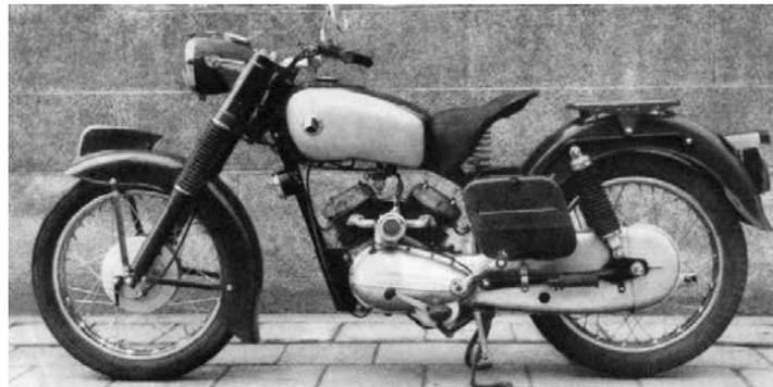
スパーク号 V型 1957年 L2075mm WB1375mm VW140kg f4 SV-2-248cc 13.2hp スイングアームを採用。
