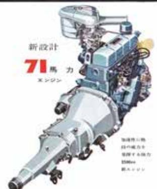
デラックスの室内と運転席。フロントシートは前後の調整ができるのみで、シートバックは固定であった。リアトランクは広いがスペアタイヤが立てて格納されていた。1957年に発売されたプリンススカイラインは既に床下にスペアタイヤが格納されていたが、セドリックはスペアタイヤの出し入れに際し、トランク内の荷物の移動が必要というものが売りであった。エンジンはフォードタウナスを参考に新開発されたと言われるG型1488cc直列4気筒71馬力で、4速MT(1速シンクロなし)を積んでいた。
