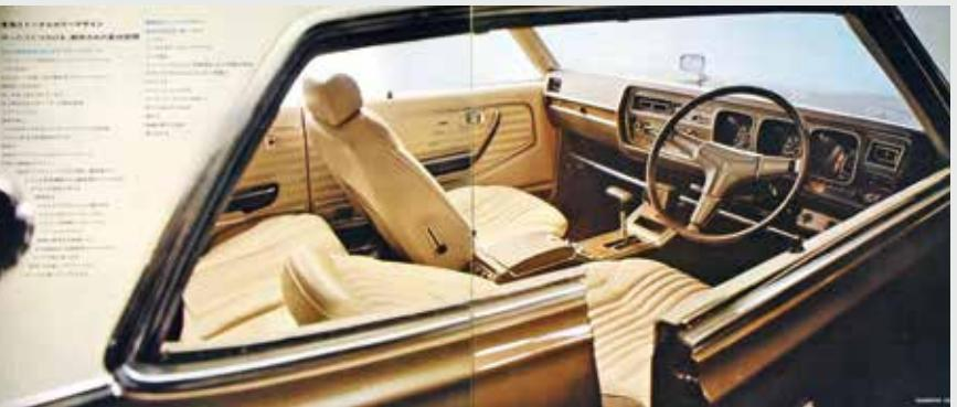
ハードトップGXの運転席と室内。GXとGLにはソフトパッド付のY形スポーツのステアリングホイールとパワーステアリング、タコメーターが標準装備され、ハードトップ全車の前席にはセミバケットタイプのセパレートシートが付き、シートバックの前倒れ操作レバーが内側にもあるので、運転席から助手席を倒すことが可能であった。ハードトップはパワーウィンドーも標準装備（デラックスは後席のみ）していた。
