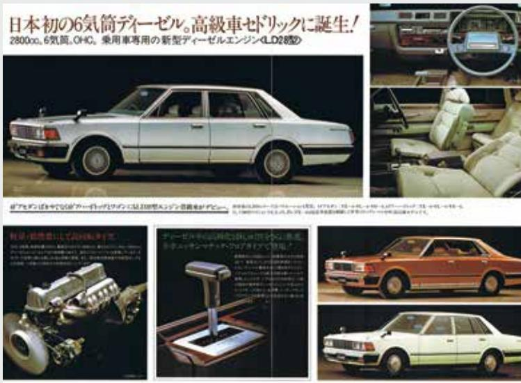
1979年10月、日本初の乗用車専用6気筒OHCディーゼル、LD28型91馬力エンジン+3速フロアATを積んだセドリックディーゼルが発売された。ディーゼル車本来の経済性に加えて、動力性能、運転性向上、騒音・振動の低減、排出ガスの清浄化など、ガソリン車に近い性能を目指し、Vシリーズ（V: Valuable Vehicleの意味）と称し、従来のセダンに加えて、新たに4ドアハードトップ及びワゴンにも搭載され、グレードもVX-6、VL-6、VS-6、VO-6と豪華仕様からスポーティー仕様まで、合計7車種を設定している。セダンにはVX-6（240.5万円）、VL-6（196.2万円）、VO-6（163.5万円）。ハードトップにはVX-6（258.2万円）、VL-6（213.1万円）、VS-6（190.3万円）、アルミホイールを標準装備）。そしてワゴン（194.3万円）がラインアップされていた。
