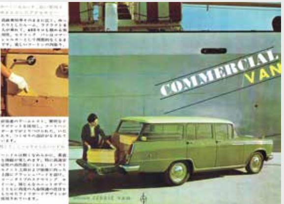
1961年2月、「広く、豪華なセドリックシリーズに、新しいコマーシャル・カー誕生」のコピーとともに新登場したセドリックバン。テールゲートはガラスを電動でゲート内に降ろした後、下ヒンジで開くタイプであった。G型1488cc直列4気筒71馬力+4速MT（1速シンクロなし）を積み、ホイールベースはセダンと同じ2530mmだが、全長は240mm長い4650mmであった。価格は78万円。
