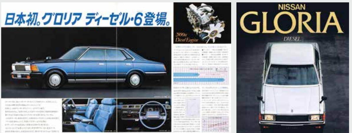
「日本初。グロリア ディーゼル・6登場。」と、アグレッシブなキャッチコピーをつけたグロリア版LD28型ディーゼル車のカタログ。写真的モデルは4ドアハードトップ280D VL-6。ガソリン車に比べ燃料代が約半分になるとアピールしている。なお、1980年2月にはセドリック／グロリアのLD28型ディーゼル車にOD付5速フロアMT仕様が追加設定されている。
