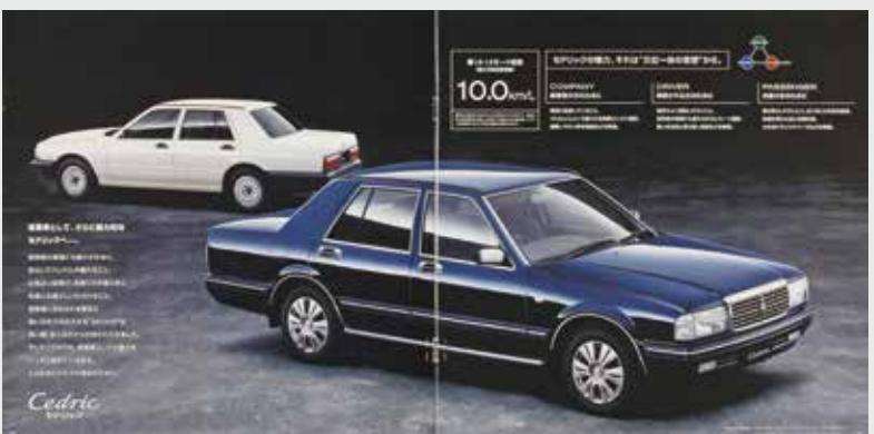
2010年9月、セドリックセダンはマイナーチェンジで、エンジンの燃料供給方式をキャブレターから液噴式に変更したLPG仕様、NA20PE型85馬力に、ATをフルレンジ電子制御4速E-ATに換装して、燃費を約12%向上した。また、タイヤサイズを185/80R14から195/65R15の低燃費タイヤに換装して燃費と操縦安定性を向上させている。価格はオリジナル：221.34万円～クラシックSV：271.11万円。
