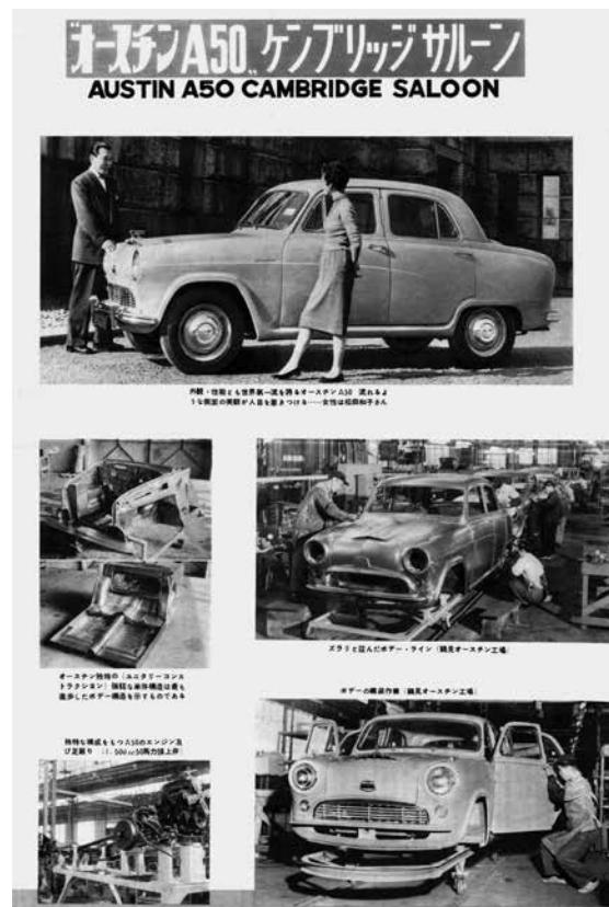
オースチンA50とボディー組み立て、儀装ライン。(1955年に発行された「ニッサングラフ・オースチントピックス」より)。
