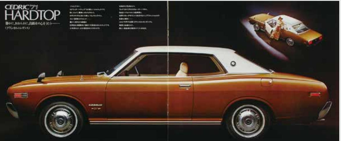
1971年2月23日に発表されたが、他のモデルより1ヶ月少し遅れて4月1日に新発売されたセドリックハードトップ。最初のカタログには「セドリックハードトップ'71」とあったが、1971年途中から'71は落とされている。これは最上級グレードのGX（138万円）で、他にGL（128万円）、スーパー・デラックス（120.3万円）およびデラックス（105万円）がラインアップされていた。GXはL20型ツインキャブ130馬力（レギュラーガソリン仕様は125馬力）+ODなし4速MTまたは3速ATを積む。ハードトップは角形ヘッドランプと立体的なフロントグリル、3分割された角形テールランプ、黒色のフィニッシャーと中央には丸く大きなエンブレムを持ち、GXとGLにはシーケンシャルターンシグナルランプ（カタログにはハミングランプとある）が採用された。GXのレザートップは標準装備。アクセントストライプはオプション。
