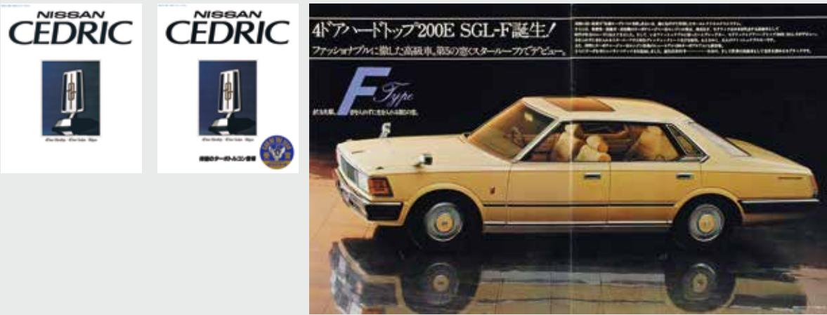
1980年4月に追加発売された、スタールーフと称するサンルーフをはじめとしたファッショナブル仕様を装備したセドリック4ドアハードトップ200E SGL-F。L20E型130馬力エンジン+OD付5速フロアMT（263.7万円）または3速フロアATを積み、クルーズコントロール、電子チューナーラジオ、テレビチューナー、ドルビー付カセットデッキなどを備えていた。チェック地のシート、ファッショナブルホイルカバーを採用していた。
