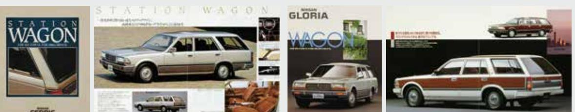
1989年6月に発行されたセドリックステーションワゴンのカタログ。呼称がワゴンからステーションワゴンに変更された。VG20E型115馬力(ネット)を搭載したV20E SGL、GL、デラックスにはパワー・エコノミー自動切り替え式OD付フルロックアップ4速ATとOD付5速フロアMTがグレードに応じて設定され、RD28型94馬力(ネット)ディーゼルを搭載した28D-6 GLにはOD付ロックアップ4速ATと5速フロアMTが設定されていた。
