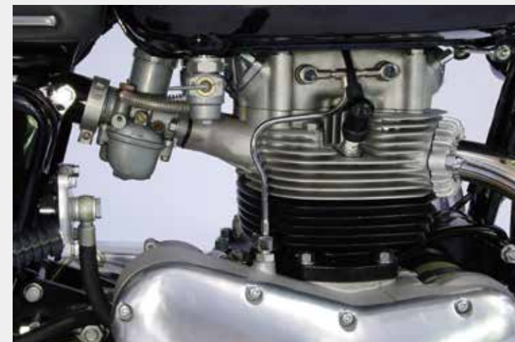
エンジンはK2では北米市場で受けないと、ボア拡大して対応。キャブレターもミクニVMの新型に、燃料コックも振動対策でネジ径が太く強化された。
