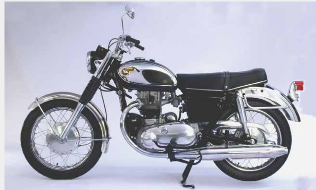
650W1は北米向け500K2試作車のフェンダーをステンレス&クローム化、タンクは同時進行中の250A1金型を流用するなどして完成した。
