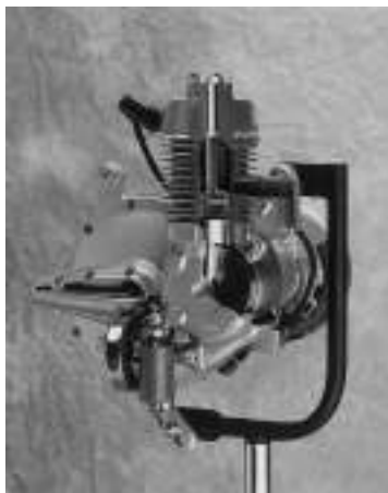
通称エントツ式エンジンのカットモデル。シリンダー上部がエントツのように飛び出していることで、名づけられたという。写真のエンジンは、当時設計を担当した河島喜好（本田技研工業2代目社長）の記憶によりホンダコレクションホールで製作された複製。
