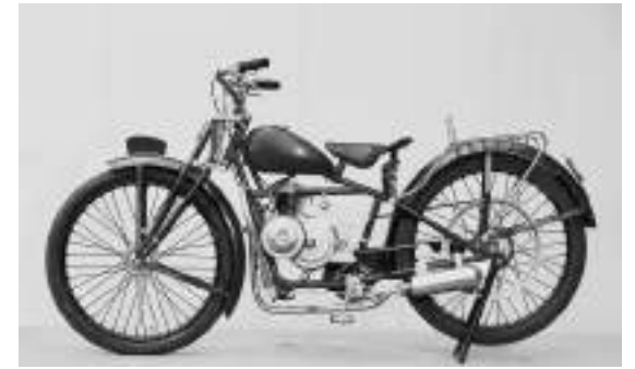
信頼性を向上させたホンダ製フレームにC型エンジンを搭載したモデル。1949年に完成した記念すべきホンダ初の完成車である。
