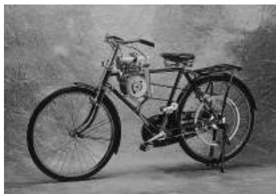
1946年に本田宗一郎が、放出品であった小型発動機を使って製作した自転車用補助エンジンは、Vベルトによる駆動方式を採用。
