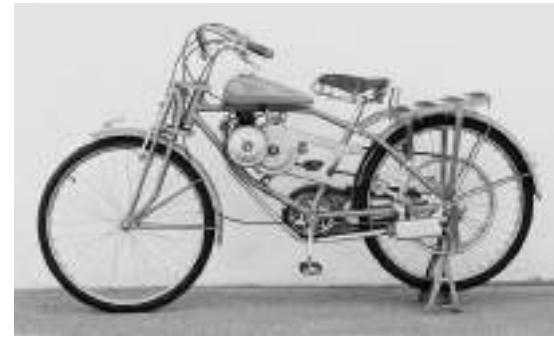
あらたに開発されたA型エンジンが装着された自転車。水滴型の燃料タンクは、鋳造湯たんぼの工場のラインで鋳造されたという。
