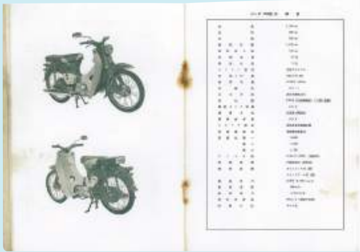
ホンダスーパーカブ C65/ パーツリスト 1964 (昭 39) 年 12 月に発売となった C65 のパーツリスト (1965 年 5 月版) スーパーカブ C65 用エンジンは、スーパーカブシリーズ系で初の OHC 機構になったエンジンであったが、このエンジンがベースになりスーパーカブ C50 (1966 年発売) に搭載された OHC エンジンが誕生することになる。排気量を示すエンブレムは、65 の文字は赤色で、レグシールドの上部には、薄青色のリフレクターが左右に装着されていた。
