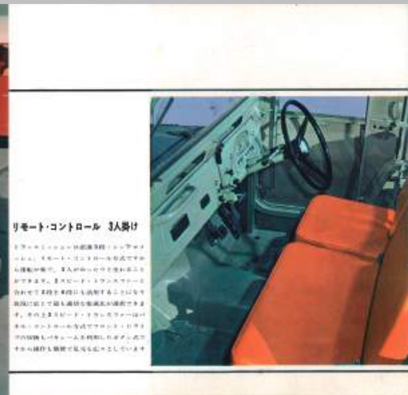
駆の切り替えもバキューム式のため足元が広い、とある。メイン写真左端のソフトトップモデルは右ハンドル仕様の国内向けだが、ページのソフトトップモデルと赤のハードトップモデルは左ハンドル仕様の輸出向けモデルである。
