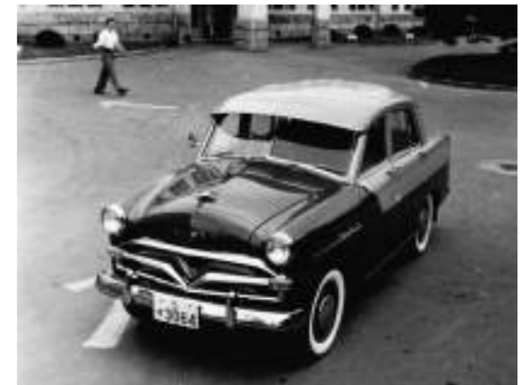
1956年3月に発売された、前輪にダブルウィッシュボーンの独立懸架を採用したプリンスセダンスペシャルAMSH-I型。
