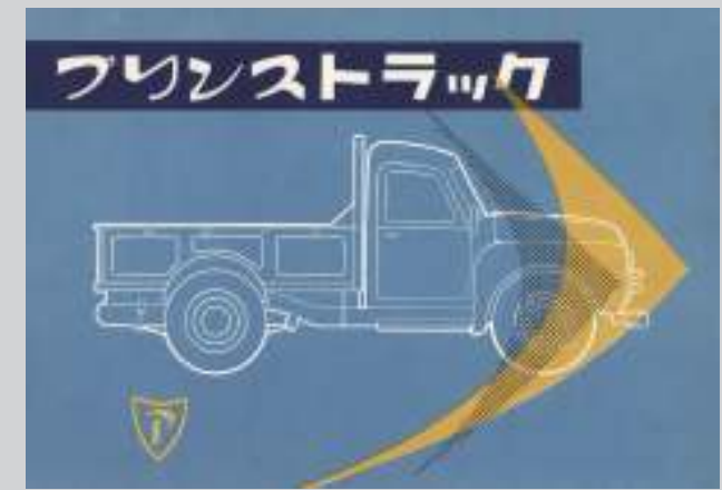
1954年4月に発売されたAFTF-4型トラック。フロントタイヤのみ700-16-10Pから700-16-6Pに変更された。価格80.5万円。
