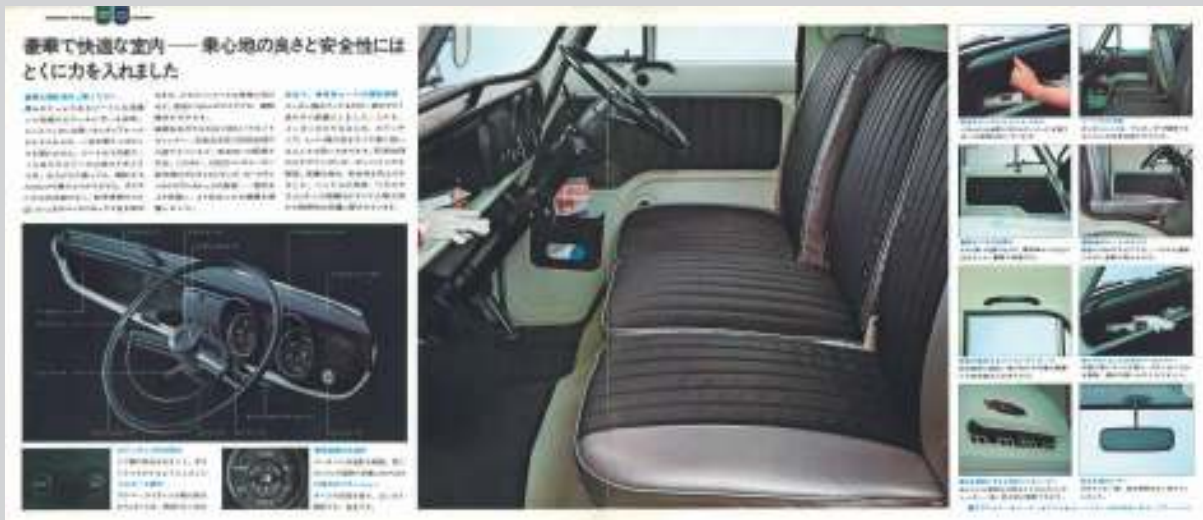
室内も一新され、メーター周りをはじめ、スイッチノブ、レバー類の色をすべて黒に統一してまぶしさを防いでいる。ステアリングにはホーンリングが追加された。シート表皮のデザインと色調も変更され、ドライバーズシートは前後に100mm スライド可能となった(従来は80mm)。ドアにはビニールレザー製のドアトリムが追加された。
