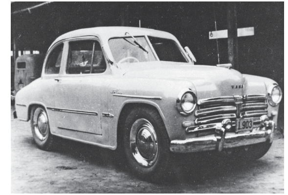
1949年3月発売された、たま・セニア(EMS-49-II型)。写真のモデルはクロームのホイールリングを付けるなど、デザイン検討用の車両と思われる。
