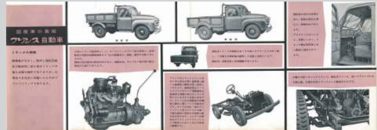
1954年4月に発売されたAFTF-4型トラック。フロントタイヤのみ700-16-10Pから700-16-6Pに変更された。価格80.5万円。
