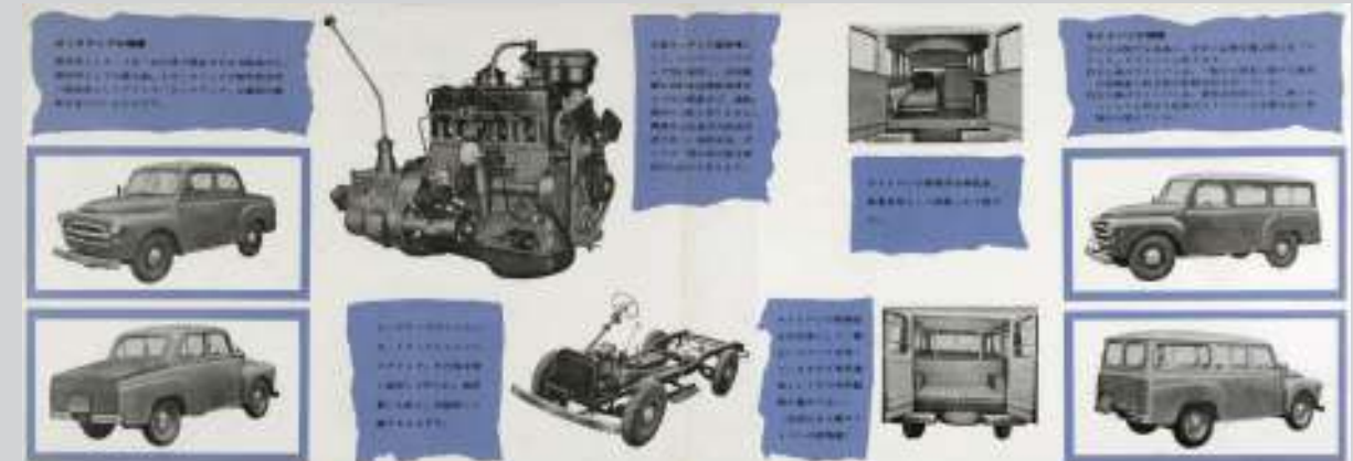
1955年1月に発売されたAFVB-2型ライトバンおよびAFPB-3型ピックアップ。このモデルまでエンジンはFG4A-11型1484cc直列4気筒OHV 45ps/4000rpm、10.0kg-m/2000rpmを積む。価格はライトバンの2人乗り97万円、5人乗り98万円、ピックアップは93万円。
