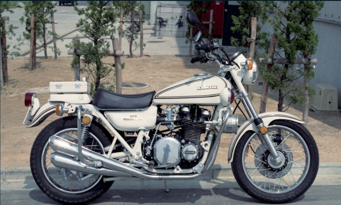
カワサキ750RS-P 初期型のカワサキ750-RS (Z2) がベースの白バイ仕様車。後期型をベースにした750RS-Pも製作されている。エンジン形式：空 4サイクル・直 4気筒・DOHC 最高出 ：69馬 /9000rpm 最大トルク：5.9kgm/7500rpm ポア×ストローク：64mm×58mm 総排気量：746cc 圧縮比：9.0 トランスミッション：5速リターン 空車重量／寸法：不明
