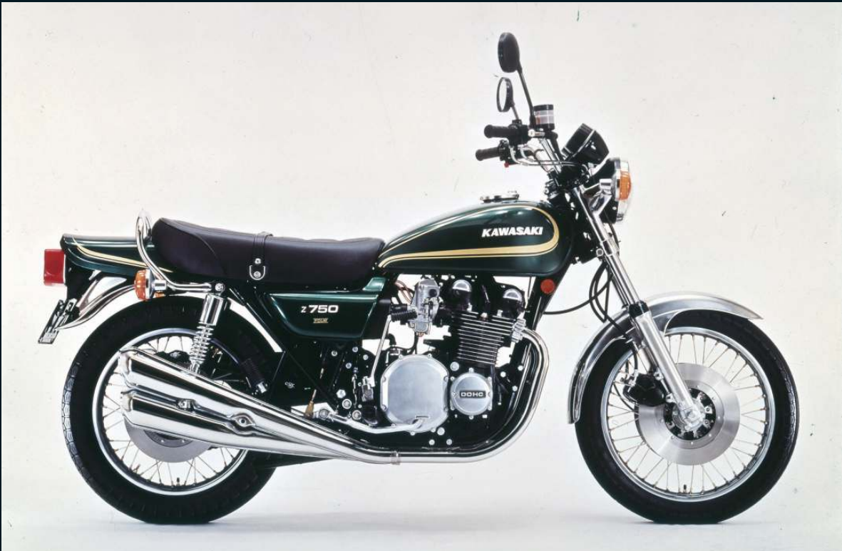
1977年－1978年 カワサキ750-RS (Z2) から始まるシリーズの最終型となったカワサキZ750FOUR (Z750D1)。キャスター角度が変更され、リアブレーキがディスクブレーキに変更され、車重も245kgに増加した。車名：カワサキZ750FOUR (Z750D) エンジン形式：空 4サイクル・直 4気筒・DOHC 最高出 ：70馬 /9000rpm 最大トルク：5.7kgm/8500rpm ポア×ストローク：64mm×58mm 総排気量：746cc 圧縮比：9.0 トランスミッション：5速リターン 燃料タンク容量：17リッター 空車重量：245kg 価格：495,000円 (スペックは1978年発表資料)
