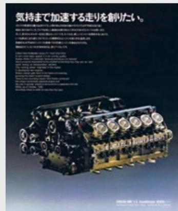
1989年の第28回東京モーターショーに参考出品されたSubaru-MM 3.5ℓ水平対向12気筒エンジン。富士重工業とイタリアのエンジンデザイナー、カルロ・キティ博士(Dr. Carlo Chiti)率いるモトリー・モデルニ(Motori Moderni)社と共同開発したF1用エンジンで、3497cc水平対向12気筒4カム60バルブ、目標最高出力650~670ps/13000rpm。1990年にイタリアのコロニ(Enzo Coloni Racing Car Systems)と組んでF1に参戦したが、戦果をあげられず6月には撤退している。
