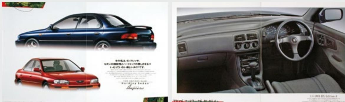
1992年11月、レオーネの後継モデルであるレガシィが大きくなり、新たな中間車「新上級大衆車」として登場した「インプレッサ」。これは伝統のサッシュレスドアを持つハードトップセダン。エンジンはいずれも水平対向4気筒SOHC16バルブで、4WD車にはEJ18型1820cc 115ps/6000rpm、15.7kg-m/4500rpmとEJ16型1597cc 100ps/14.1kg-m、そしてFF車にはEJ15型1493cc 97ps/13.2kg-mを積む。これにE-4速ATまたは5速MTが付く。サイズは全長4350mm、全幅1690mm、全高1415(FFは1405)mm、ホイールベース2520mmで、車両重量990～1170kg。価格は122.2～202.2万円。
