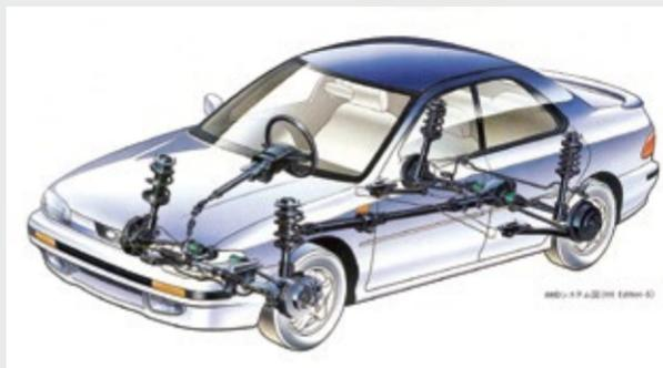
インプレッサのサスペンションはフロントがL型ロアアーム・ストラット、リヤはデュアルリンク・ストラットの4輪独立懸架で、全車フロントにはベンチレーテッド・ディスクブレーキを標準装備し、4WDはAT車にはアクティブトルクスプリット方式、MT車にはビスカスLSD付きセンターデフ方式が採用されている。
