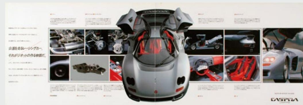
1989年に発行されたジオットキャスピタのカタログ(25cm×35.5cm、10頁)。「公道を走るレーシングカー。それがジオットの作る物語だ。」のキャッチコピーが夢を掻き立てる。エンジンは3.5ℓ Subaru-MM 12気筒450ps以上/37.0kg-mをミッドシップに積む。フルカーボンコンポジット・モノコックフレームとカーボンファイバーのカウリングを採用し、サイズは全長4534mm、全幅1996mm、全高1136mm(最低地上高130mm時)、ホイールベース2700mm、最低地上高70mm/130mm切り替え式、車両重量1100kg。富士重工業がF1から撤退したためエンジンの供給が断たれ、英国のエンジンディベロップメンツ社 (Engine Developments Ltd.) 製ジャッド (Judd) 3.5ℓ V10エンジンを換装し、1993年に2台生産されたが、折からのバブル景気崩壊とともに夢の実現はかなわなかった。
