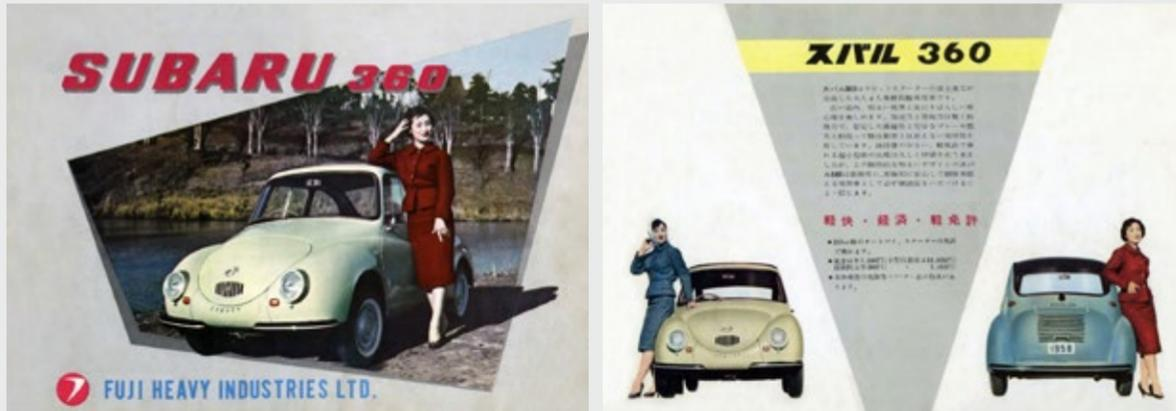
1958年3月3日に発表され、5月1日発売された、富士重工業最初の市販軽乗用車、スバル360増加試作型。東京地区で50台が限定販売された。価格は42.5万円。全長2990mm、全幅1300mm、全高1380mm、ホイールベース1800mm。中島飛行機時代の航空機製造ノウハウを活かした車両重量は385kgと軽量であった。最高速度83.0km/h。表紙のモデルは女優の馬淵晴子。
