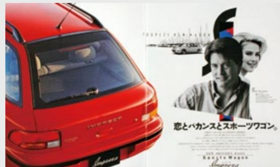
セダンと同時に発売されたインプレッサ スポーツワゴン。セダンと全く同じ全長のコンパクトワゴンで、1.8ℓ4WDと1.6ℓFFがあり、4WDにはスイッチ操作により40mmの高アアップが可能なハイトコントロール機能を持つ電子制御エアサスペンション(EP-S)装着車も設定されており、エアサス車の5速MTはデュアルレンジ付きであった。価格は137.0～207.0万円。
