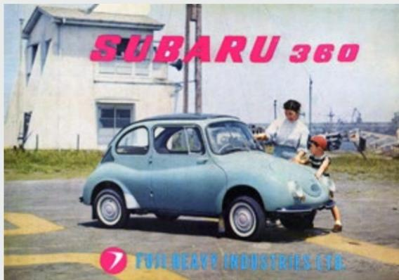
1958年7月発売された58年後期型。ドアガラスは引き戸式のまま三角窓が新設され、右側後方の吸気用エアダクトグリルが追加された。プレス型の再調整により、ボディ全体が増加試作型に比べ丸みをおびている。モデルは女優の青山京子。
