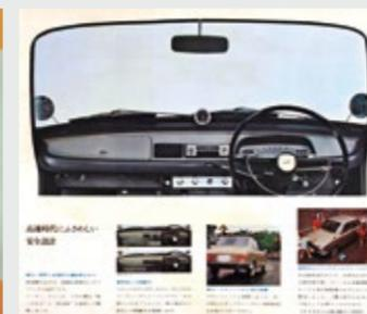
1966年5月発売されたスバル1000 4ドアセダン。スタンダード、デラックス、スーパーデラックスがラインナップされ、全長3930mm(スタンダードは3900mm)、全幅1480mm、全高1390mm、ホイールベース2400mm、車両重量670～695kg、最高速度130km/hであった。運転席まわりはシンプルで、FFの強みである室内足元の広さは抜群であった。価格は49.5～58万円。
