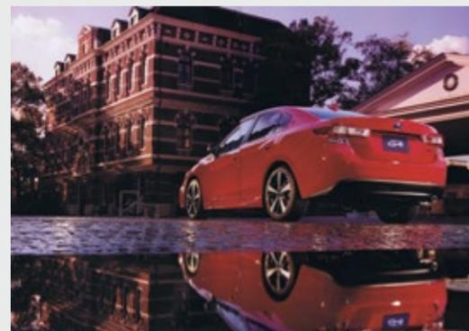
2016年10月(1.6ℓ車は12月)発売された5代目インプレッサ SPORT (シルバー) / G4 (レッド)。エンジンは燃料システムの直噴化をはじめ、約80%の部品の設計を見直し、約12kgの軽量化を実現した2.0ℓNAのFB20型154ps/20.0kg-m、および従来モデルをベースに改良を加えた1.6ℓNAのFB16型115ps/15.1kg-mの2種が設定され、これに、改良により約7.8kg軽量化された7段のマニュアルモード付リニアトロンニック(CVT)が装着される。駆動方式は2WDとAWDを全グレードに設定。サイズ(カッコ内はG4)は全長4460(4625)mm、全幅1775mm、全高1480(1455)mm、ホイールベース2670mm。価格はSPORT / G4とも同じで1.6ℓモデル178万円(2WD)、198万円(AWD)、2.0ℓモデルは200~240万円。
