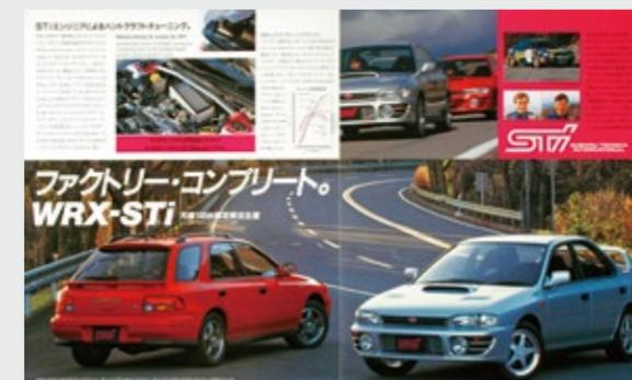
1994年1月、セダン/ワゴン合わせて月産100台限定受注生産された、インプレッサ初のSTI社チューンのファクトリー・コンプリートカー「WRX-STI」。鍛造ピストン、軽量ラッシュアジャスター、専用ECU、強化インタークーラーダクト、インタークーラーウォータースプレーと専用ノズル、STI/フジツボ製大径(101.6φ)マフラーを装備、ワゴンはタービン、カムシャフトをセダンWRXと共通の高出力型に変更、エンジン出力は250psに達し、セダンは10ps、ワゴンは30psのパワーアップを果たしている。そのほかSTIフロントストラットタワーバー、耐フェード性に優れたフロントブレーキパッド、エクセーナシート、STI/ナルディステアリング、大型リヤスポイラー(セダン)などを装備する。価格はセダン277.8万円、ワゴン285.8万円。
