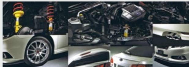
2012年11月13日に発売し、翌年3月12日受注分までの限定300台が販売されたレガシーツーリングワゴン/B4「2.5i EyeSight tS」。「tS」シリーズ初の自然吸気となる2.5ℓ新世代ボクサーFB25型173psエンジン+リニアトロニックとアイドリングストップに加え、アイサイトVer.2を搭載する。STIチューンの前後ダンパー（ビルシュタイン製）やコイルスプリング、フレキシブルタワーバーフロント、リヤサスのラテラルリンク外側に加え、内側にもピロロールブッシュを採用するなどのチューニングが施されている。外装では塗色にWRブルー・マイカを専用設定し、STI製18インチアルミホイール、フロントアンダースポイラー、リヤスポイラーを装備。内装には、専用のアルカンターラと本草を組み合わせたシート、専用ルミネセントメーター、本草巻セレクトレバーなどを装着して上質感を演出している。価格はツーリングワゴンが351万円、B4は336万円。
