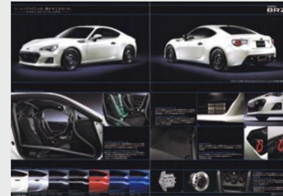
2013年1月に追加設定されたBRZ RA Racing。ワンメイクレース「GAZOO Racing 86/BRZ Race」参戦用車両としてBRZ RAをベースに、前後ベンチレーテッドディスクブレーキ、専用ブレーキダクトとブレーキバックプレート、トルセンLSD、空冷式エンジンオイルクーラー、4点式シートベルト、6点式ロールオーバー、マニュアルエアコン、専用フロアマット(運転席/助手席)、前後トランスポートフックなどのレース用架装を施したモデル。価格は273万1429円(税込286.8万円)。車両保証は、レース等モータースポーツ参加時点で、ベース車及び架装部分共に保証無効となる。
