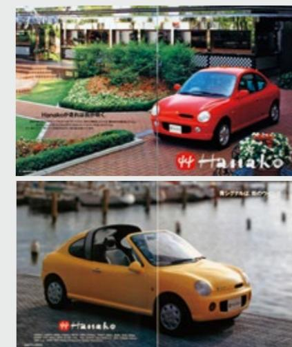
1991年の第29回東京モーターショーに参考出品された軽自動車「ハナコ (Hanako)」。マガジンハウス社とタイアップして女性誌「Hanako」のネーミングを使用した、女性をターゲットとした2シータースポーツ・カジュアルの提案。658cc直列4気筒48psエンジンにファジー制御ECVTを積む。赤いクーペと黄色のタルガトップが展示された。カタログの「Hanako」の文字はオーストラリアのアーティスト、ケンドーン (Ken Done) の作品。
