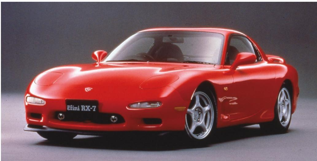
デザインやメカニズムの開発、広範囲なテストを経てデビューしたFD型RX-7。フロントオーバーハングと全長を短縮する一方で全幅を拡大、全高も低くしたワイド&ローのフォルムは、3次元曲面により光の反射が印象的なものとなった
