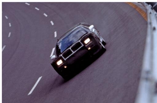
広島県三次市にあるマツダのテストコースで、高速耐久試験を行っているテスト車。大型のフロントグリルがあるかのような偽装が施されている
