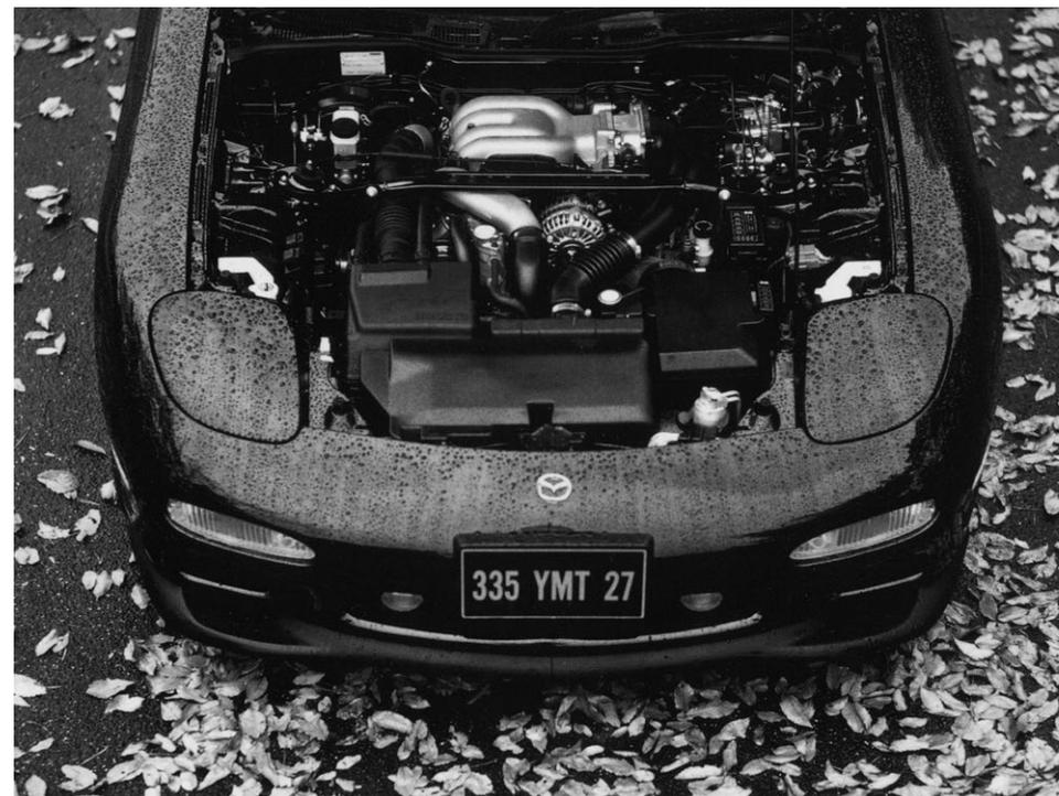
最高出力だけでなく、高回転域のパワーも向上させたロータリーエンジンが、コンパクトにエンジンルームに収まっている
