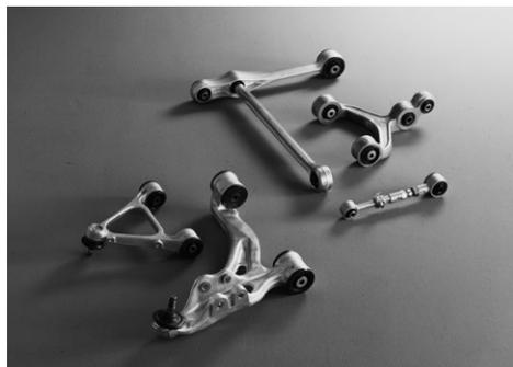
FDのサスペンションはばね下重量低減を狙い、コントロールロッド以外の構成部品をアルミ化することを具現化した
