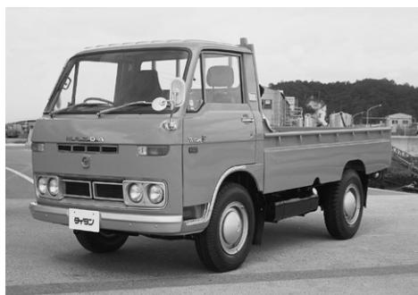
初代タイタン、本格キャブオーバー型トラックをEシリーズの後継として導入、頑強な閉断面フレームと高強度のリーフスプリング及び横剛性を高くする、他社にはない高強度な樹脂ワッシャを装着していた
