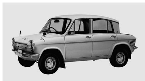
キャロルは4人乗りの軽乗用車、360ccクラスながら4サイクル4気筒でリアエンジン後輪駆動、トーションラバースプリングの4輪独立懸架サスペンションを採用
