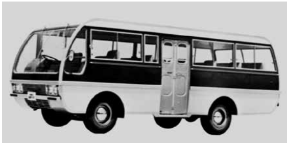
25人乗りのキャブオーバータイプライトバスAEVA(A)型。81PS、15.5kg mを発揮する1985cc VA型ガソリンエンジンを搭載していた。
