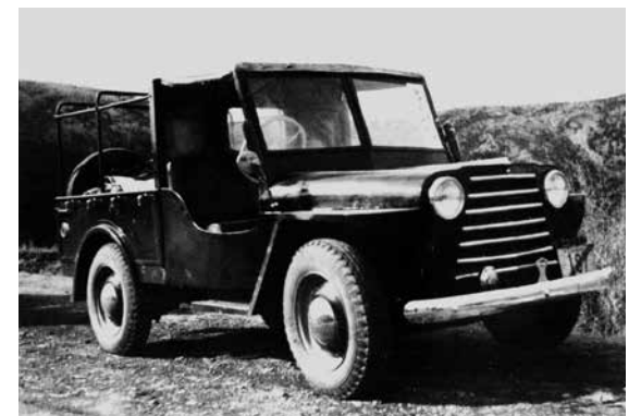
ジープタイプの1t積み車として開発されていたCA型小型四輪トラック。CT型三輪トラックの機構を採用することでコストを抑えることに成功した。
