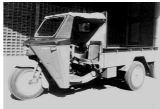
GB型からHB型、さらにGCZ型へとフルモデルチェンジされた750kg積み車の三輪トラック。写真は1灯式最終型のGCZ後期型。
