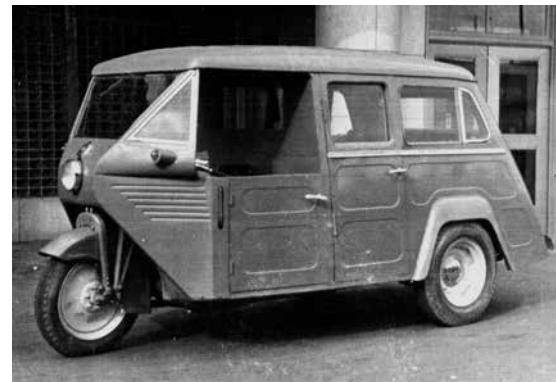
本格的な三輪乗用車として開発されたPB型。701ccエンジンを搭載し、6人乗車が可能だった。
