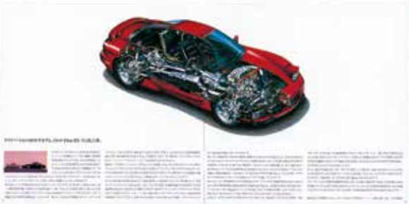
255PS/6500rpm、30.0kgm/5000rpmを発揮する654cc×2ローターの13B型シーケンシャルツインターボ付きロータリーエンジンをフロントミッドシップに搭載して前後重量配分50：50を実現。独自のスペースモノコックボディにはオールアルミ製4輪ダブルウィッシュボーン式サスペンションやP.P.F.（パワープラントフレーム）、トルセンLSDなどが採用されている。
