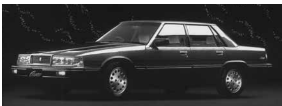
コスモ4ドアハードトップロータリーターボには、165PS、23.0kg mの573cc×2ローター12A型ロータリーターボエンジンを搭載した。
