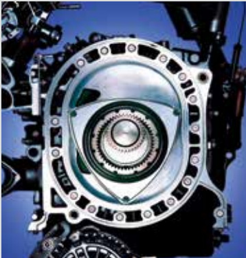
RX-8に搭載されている新世代ロータリーエンジンのRENESIS。サイド排気、サイド吸気のポートレイアウトを採用したRENESISは吸排気ポートタイミングのオーバーラップを解消、さらに吸気ポート面積を広く取り吸気抵抗を削減、未燃焼ガスを次の燃焼行程に送り込んで再燃焼させることで排出量を大幅に低減して、排気エミッションを従来ロータリーエンジンに比べて1／10以下に抑制した。自然吸気ロータリーエンジン本来のコンパクト化にも成功している。
