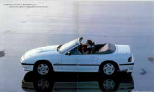
昭和62年(1987年) 8月に追加設定されたサバンナRX-7カブリオレ。トップのルーフ部に樹脂成型のハードパネルを採用した3ウェイトップやオープン時にもクロズドの快適性を保つエアロカプセルキャビンが特徴。
