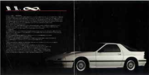
2シーター化に加え、アルミ製ボンネットフードや特注のBBS製鍛造アルミホイールなどを採用し、徹底的な軽量化を図った限定車のサバンナRX-7∞（アンフィニ）バージョン。
