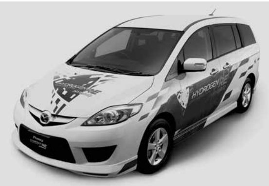
水素ロータリーエンジンと独自開発したハイブリッドシステムを組み合わせたプレマシーハイドロジェンREハイブリッド。RX-8ハイドロジェンREに比べてパワーユニット出力を約40%向上、水素航続距離は2倍の200kmを達成している。
