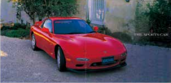
3代目RX-7は平成3年(1991年) 12月にアンフィニRX-7としてデビュー。オリジナリティ溢れる3次元曲面の美しいエクステリアには、初代から受け継いだリトラクタブルヘッドランプを採用。各部位の軽量化を徹底したピュアスポーツカーに生まれ変わった。
