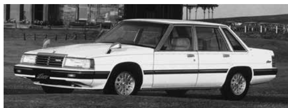
160PS、20.5kg mの654cc×2ローター13B型ロータリーエンジンを搭載したルーチェサルーンロータリースーパーインジェクション。
