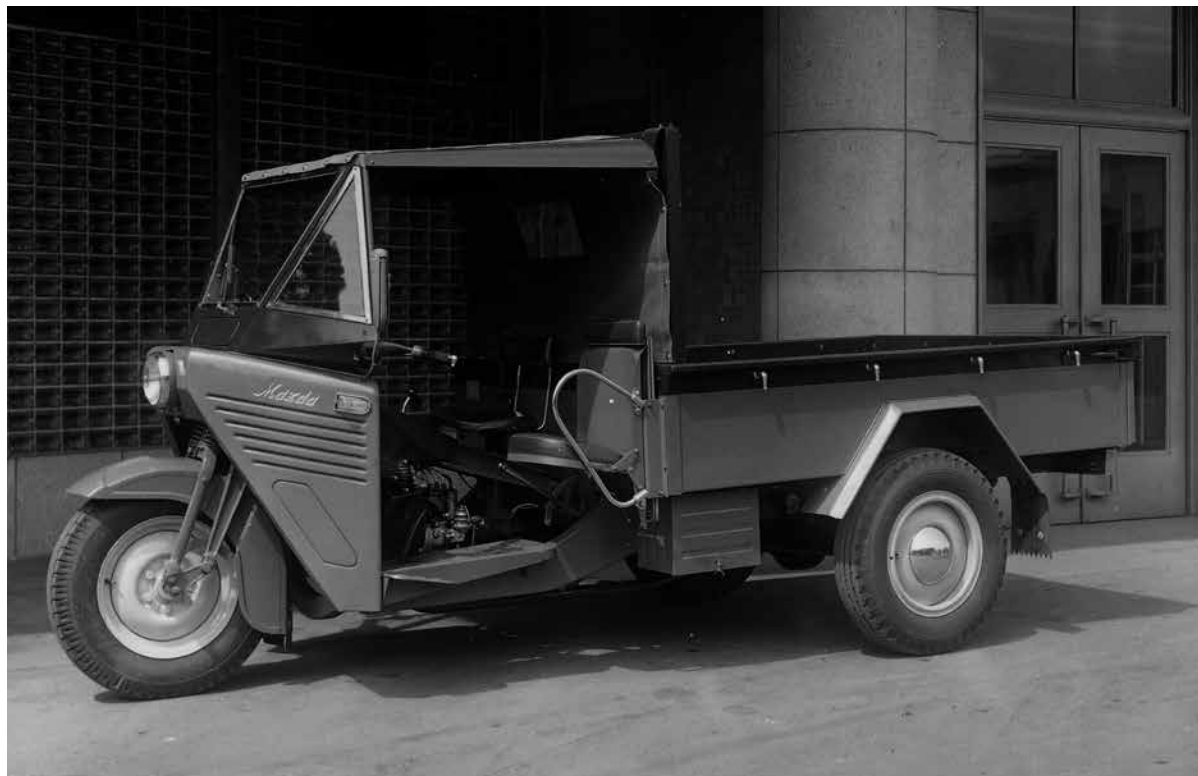
全長3920mm×全幅1635mm×全高1805mm、最小回転半径4.5m(CLY71)と扱いやすさで人気を博したCLY型三輪トラック。
