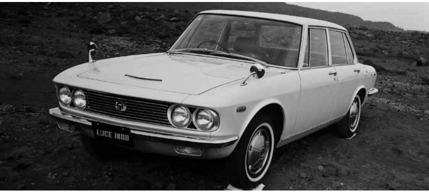
100PS、15.5kg mを発揮する新開発1796cc 4気筒OHCのVB型エンジンを搭載したルーチェ 1800。
