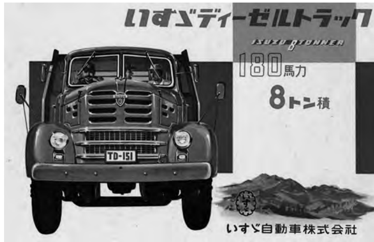
TD151 8トン積のイラストが描かれたカタログ表紙。 運転席と助手席の横から長いステーの先に装着されているのが機械式の矢羽式方向指示器。生産企業の社名から「アボロ」が代名詞となっていた。
