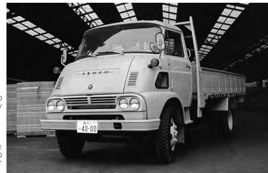
TY31 4トン積(1969年) L6275 W2190 H2340 WB3650 VW3175kg F5/ R1 100km/h 7.50-16 <D400>D-予-L6-3988cc 102ps/3400rpm 25.0kgm/1800rpm D370型エンジンの排気量を 4リッターにアップしたD400 型を搭載、グリル回りのデザイ ンも変更された。
