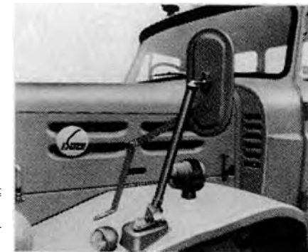
可倒式サイドミラー。歩行者等に接触した場合、後方に倒れ、衝撃を緩衝できる構造になっている。
