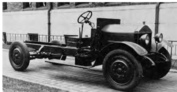
鶴見工場に保管されていたウーズレーCPTトラック1号車。足動制動機を推進軸制動機に連動させて制動力は好評。1940（昭和15）年10月、東京の国立科学博物館に寄贈。
