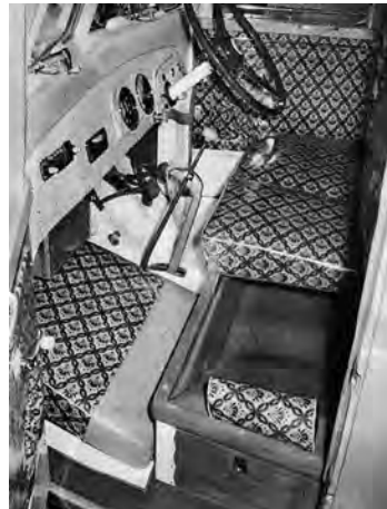
(左) TD151系の運転室。当時のフロントガラスは上部を支点に前方に開く構造で、通気性は抜群であった。 (右) シート下は、仮眠用ベッドになる構造。
