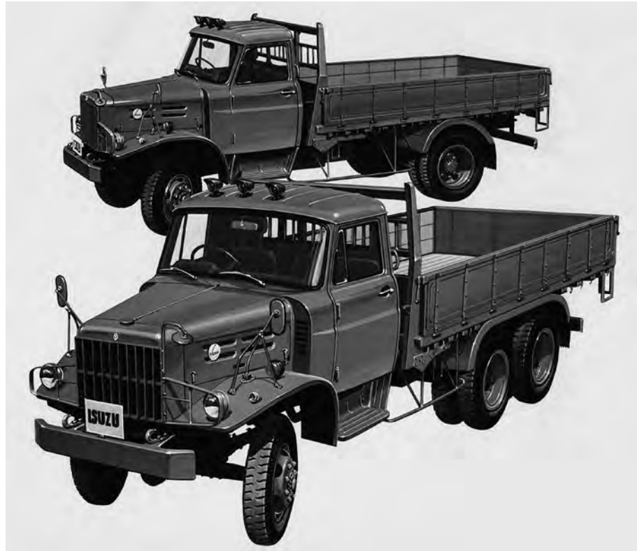
TWD20 6トン積(1973年) L7040 W2390 H2460 WB4580 VW5680kg F4/R1×2 70km/h 8.25-20 〈DA120〉D-予-L6-6126cc 125ps-39.5kgm
