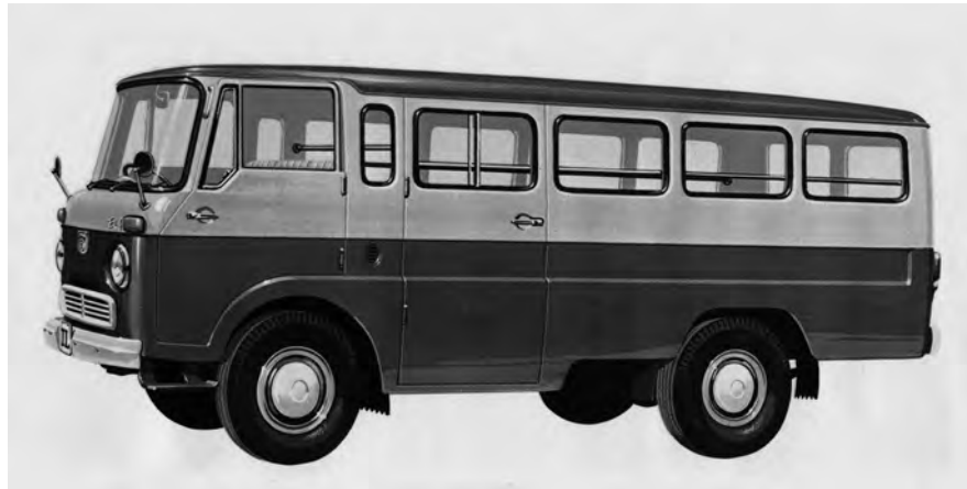
TLG10V/TLD10V ルートバン (1963年) L4295 W1690 H1990 WB2180 〈GL150〉72ps/〈DL201〉55ps ホイールベース2460mmのTLG20V/ TLD20Vもあった。
