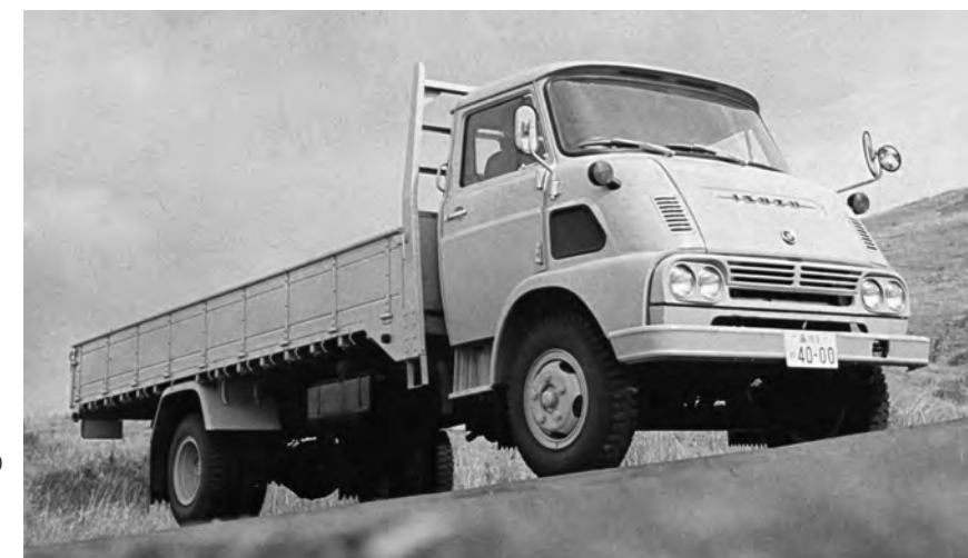
TY31S 3.5トン積(1968年) L6275 W2190 H2340 WB3650 VW3165kg 100km/h 7.50-16 <D400>102ps-25.0kgm
