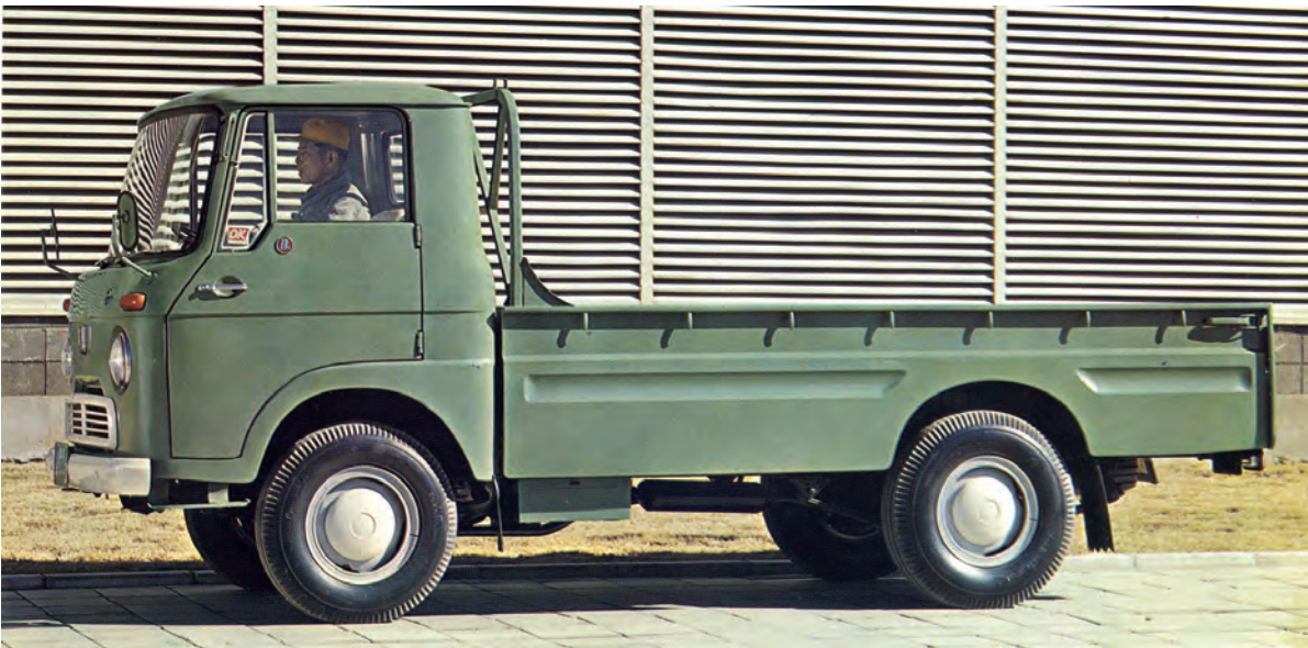
エルフ TLD20 2トン積(1963年) L4690 W1690 H1990 WB2460 VW1540kg 85km/h 〈DL201〉D-予-L4-1991cc 55ps-12.3kgm
