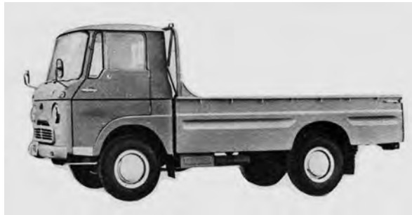
TLD21(1964年) L4690 W1690 H1990 WB2460 95km/h F:7.00-15/R:7.50-15 〈C220〉D-予-L4-2207cc 62ps/3600rpm 14.2kgm/2200rpm DL201型エンジンのストロークを10mmアップしたC220型エンジンを 搭載。排気量は2207cc、出力も62psにアップ。
