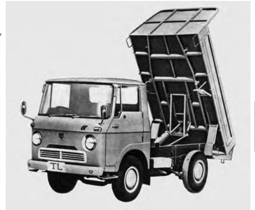
TLD11D ダンプ(1964年) L4235 W1690 H1985 WB2180 VW1935kg 95km/h 〈C220〉62ps-14.2kgm 経済性と小回りを誇るエルフディーゼルダンプ で、ガソリン仕様もある。
