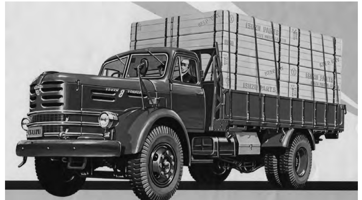
TD151 8トン積(1961年) L8085 W2460 H2560 WB4800 VW5730kg F5/R1 106km/h 10.00-20 〈DH100〉D-予-L6-10179cc 190ps-67.0kgm DH100型エンジンは190psにパワーアップした。補助ブレーキとして排気ブレーキが装備された。
