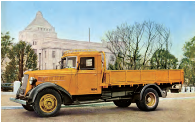
ウーズレー CPトラック(1924年)東京石川島造船所 L5410 W1830 WB3660 VW1672.8kg 1.5トン積 F4/R1 44.8km/h 〈CP〉G-SV-L4-26hp
