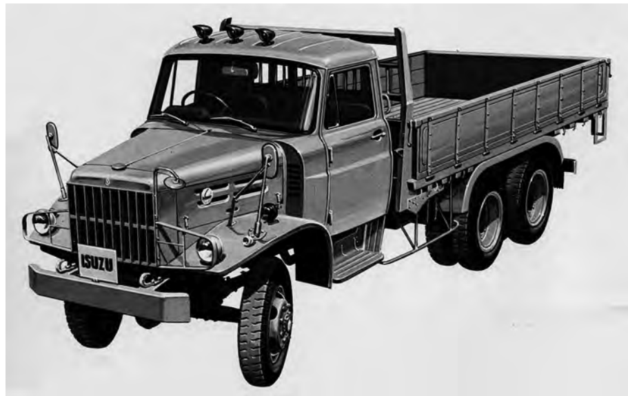
TWD23 6トン積(1974年) L7040 W2390 H2530 WB4580 VW5765kg F4/R1×2 70km/h 8.25-20 〈DA640〉D-予-L6-6373cc 135ps-41.5kgm
