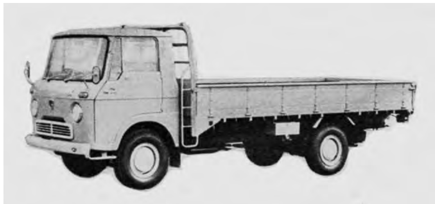
TLD30A ロング(1964年) L5750 W1990 H2050 WB3160 VW1910kg 85km/h 〈C220〉62ps-14.2kgm ホイールベースを延長して4.07mの 長尺荷台を架装。道路運送車両法の 小型車規格(全長4.7m以下)を超え るので、普通車登録された。
