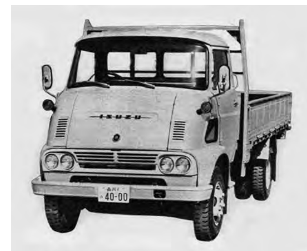
TY31S 3.5トン積(1968年) L6275 W2190 H2340 WB3650 VW3165kg 100km/h 7.50-16 <D400>102ps-25.0kgm
