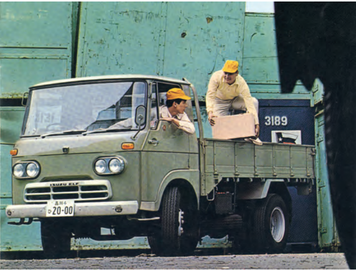
エルフ TLD20 2トン積(1963年) L4690 W1690 H1990 WB2460 VW1540kg 85km/h 〈DL201〉D-予-L4-1991cc 55ps-12.3kgm
