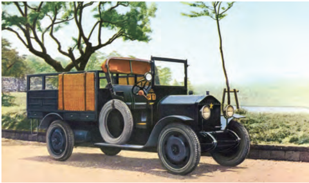
ウーズレー CPトラック(1924年)東京石川島造船所 L5410 W1830 WB3660 VW1672.8kg 1.5トン積 F4/R1 44.8km/h 〈CP〉G-SV-L4-26hp
