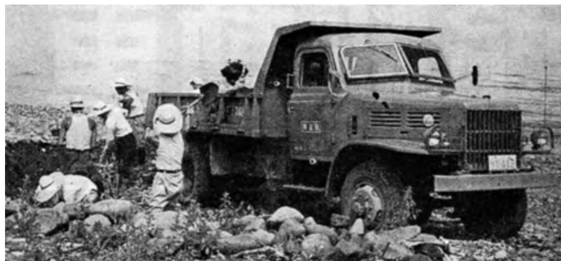
TS11 5トン積ダンプ(2点共) WB4000 7.50-20 〈DA48〉D-予-L6-5654cc 100hp DA45型の後継、DA48型エンジンを搭載。
