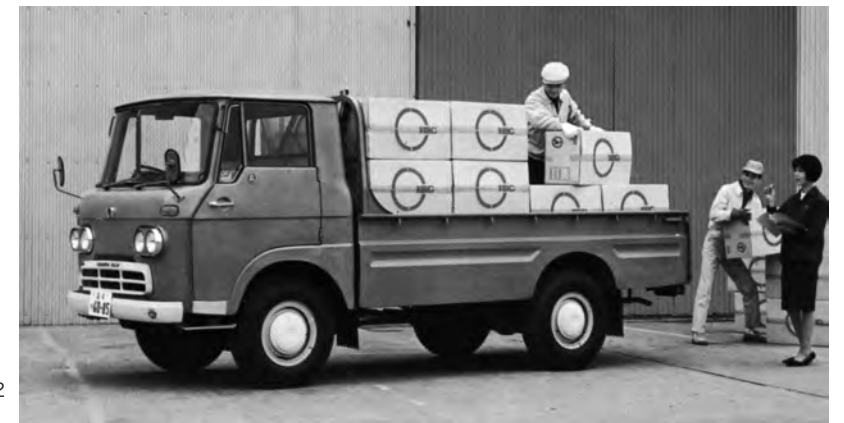
TLD21(1965年) 〈C220〉D-予-L4-2207cc 62ps/3600rpm 14.2kgm/2200rpm TLG21(1965年) 〈GL201〉G-OHV-L4-1991cc 85ps/4600rpm 15.3kgm/1800rpm 小型トラックで最も長い3.02mの荷台をもつ2 トン積トラック。
