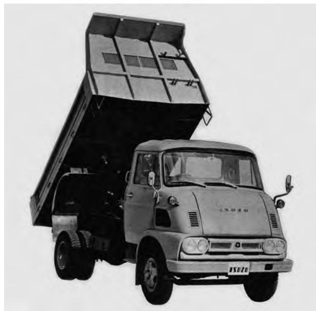
TY20D 4トン積ダンプ(1966年) L5260 W2100 H2430 WB3200 VW3495kg F5/R1 100km/h 7.50-16 <D370>100ps-23.0kgm 小型車の機動性と大型車並みの荷台容積を兼ね備えた4トン積ダンプである。
