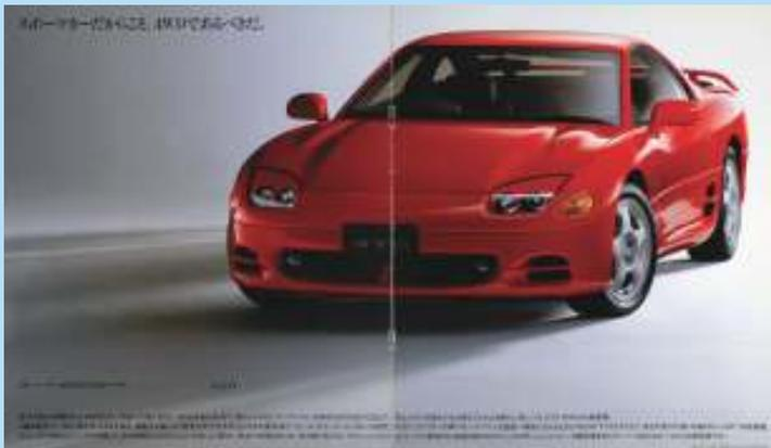
1993年8月27日、マイナーチェンジでリトラクタブルヘッドランプからプロジェクター4灯式に変更され、その他内外装の改良が実施されたGTO。ツインターボモデルにはドイツ、ゲトラーク(Getrag)社製6速MT、235/45ZR17タイヤが採用された。
