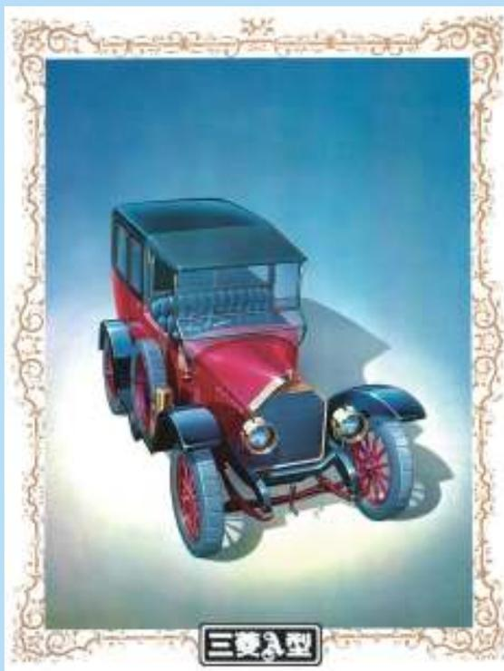
**三菱A型** 1972(昭和47)年10月、東京晴海で開催された第19回東京モーターショーで配布された三菱自動車総合カタログの表紙を飾った三菱A型。1917年夏頃から三菱造船神戸造船所でフィアットを手本に試作開始し、1918年11月に完成している。当初は三菱甲型と称した。わが国初の見込み生産された乗用車で、三菱で最初の自動車販売会社「大手商会」を三菱造船と三菱商事の共同出資により設立し販売された。残念ながら1921年に生産中止、1922年2月には大手商会も解散してしまった。ホイールベース2743mm、トレッド1422mm、エンジンは4気筒2540cc(ボア79.4mm×ストローク128.3mm)、35ps。箱型と幌型があり定員は7名。生産台数は試作車5台を含めわずか22台であった。
