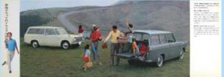
1963年10月発売されたコルト1000バン。ミニバンなど無い時代、バンは「レジャーカーとしてもうってつけです」と訴求している。サイズは全長3905mm、全幅1490mm、全高1470mm、ホイールベースは2285mm、車両重量880kg(スタンダードは865kg)、最高速度122km/h、2名+400kgあるいは5名+200kg。エンジンはKE43型直列4気筒977cc、51ps/6000rpm、7.3kg-m/3800rpm。価格はデラックス58.8万円、スタンダード55.3万円。
