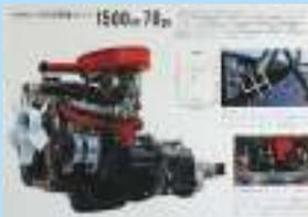
スバルも性能も室内もすべてが最大の水準です。コルト1500は、1965年10月に発売された。この車は、三菱の技術とスバルの性能を兼ね備えています。エンジンは、KE45型直列4気筒OHV 1498cc、70ps/5000rpm、11.5kg-m/3000rpm。価格は64.8万円。
