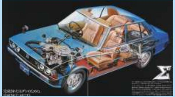
ギャランΣのサスペンションは前輪がI型アーム式ストラットタイプ、後輪はリジッドアックスル+アシストリンク付き4リンクを採用。エンジンは4G52型アストロン80 1995cc、105(ツインキャブ仕様は115)ps、4G51型アストロン80、1855cc 97psと4G32型サターン1597cc、92(同100)psの5種。全車 MCA システム搭載で51年規制に合格している。
