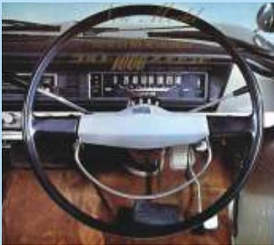
1964年10月、コルト1000に「スキヤット(Single Coupling AT)」の名前で、電磁クラッチと3速MTを組み合わせたフルATが登場。三菱電機が英国のスミス社、フランスのジャージャー社と技術提携して開発したもの。Dレンジでは自動的に最適なギアを選択、2レンジは2速固定、1速に固定したいときはインストゥルメントパネル上の「ホールドワンスイッチ」をONにする。短期間でカタログから落とされてしまった。
