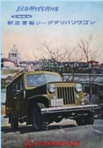
1956年に発売されたジープデリバリワゴン J11型。A、B、Cの3型式あり、AおよびB型はホイールベース2032mmで、A型のリヤドアは上下開き、B型は左右開きでリヤバンパーが2分割されており、中央にパワー・テーク・オフあるいはトレーラー用フックを取り付け可能。C型はホイールベース2532mmでリアドアは上下開きであった。まだフロントグリル上部の車名はWILLYSのままである。
