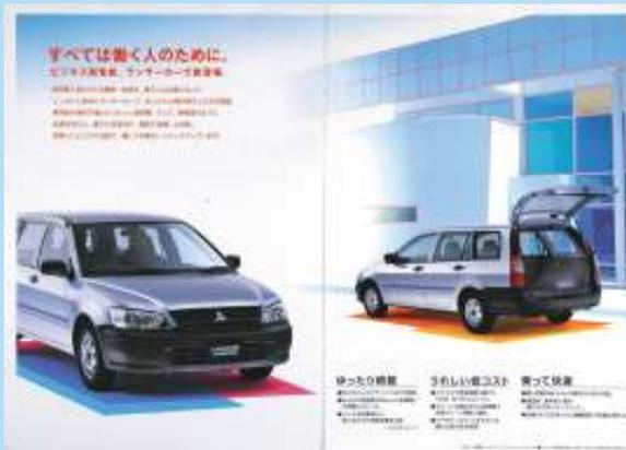
2003年1月6日、リベロカーゴの後継としてランサーカーゴが発売された。セディアの名称は付かない。定員+最大積載量は2名+400kgまたは5名+250kg。エンジンは4G15型1468cc 66ps。2WDには5速MTまたはINVECS-III CVT、4WDにはINVECS-II 4ATが付く。
