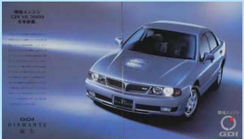
1997年8月19日、改良型ディアマンテが発売された(発表は7月29日)。エンジンを3.0L 6G72型GDI(ガソリン筒内直接噴射) 240psに換装、2.5L車はカタログから落とされた。ATは全車INVECS-IIスポーツモード5速が付く。安全強化ボディRISE採用。SRSサイドエアバッグも上位グレード(SE-R、SE-G)に標準装備、他はメーカーオプション。最上位グレードSE-Rに初めてチルトに加えテレスコピックステアリング(電動)が採用された。
