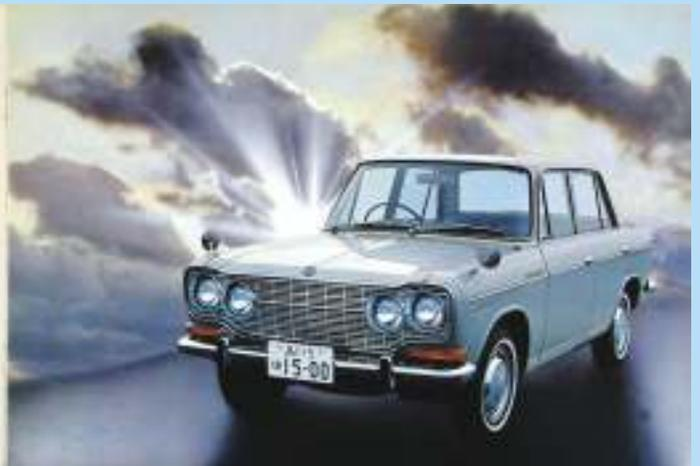
1965年7月には名神高速道路が全線開通し、ハイウェイ時代の到来とともに高出力車の需要も増えてきた。この市場のニーズに応え、コルトシリーズの充実を図るため、1965年10月にコルト1500を発売。4灯式ヘッドランプを採用。サイズはコルト1000より若干長く、全長3975mm、全幅1490mm、全高1425mm、ホイールベースは2350mm、車両重量920kg、最高速度140km/h。エンジンは、KE45型直列4気筒OHV 1498cc、70ps/5000rpm、11.5kg-m/3000rpm。価格は64.8万円。
