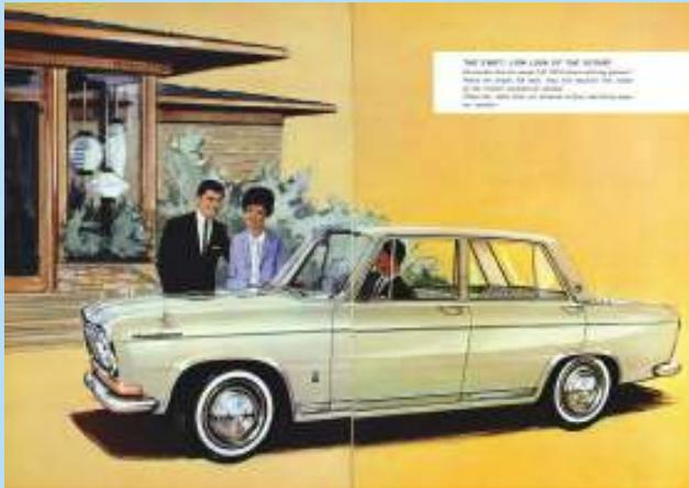
三菱の小型乗用車市場参入の第2弾として1963年7月発売されたコルト1000。これは全頁イラストで構成された輸出用英文カタログ。サイズは全長3830mm、全幅1490mm、全高1420mm、ホイールベースは2285mm、車両重量850kg(スタンダードは830kg)、最高速度125km/h、定員5名。エンジンはKE43型直列4気筒977cc、51ps/6000rpm、7.3kg-m/3800rpm。価格はデラックス66.3万円、スタンダード58.3万円。1年後にはそれぞれ2万円値下げされている。1964年5月、営業用LPG車も追加設定された。ちなみに、4ヵ月後に2代目スカイラインが非常に似た姿で登場した。
