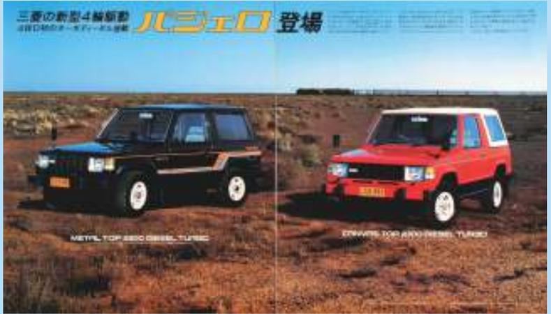
1982年5月7日に発売された初代パジェロ。メタルトップ(左側)4車種とキャンバストップ(右側)3車種の合計7車種でスタートした。サイズは全長3870(ターボ:モデル3930)mm、全幅1680mm、全高1855(ターボモデル:1845)mm、ホイールベース2350mm、車両重量1285~1450kg。乗車定員+最大積載量2名+400kgまたは5名+0kg。価格はメタルトップ146.4~189.0万円、キャンバストップ135.6~169.5万円。
