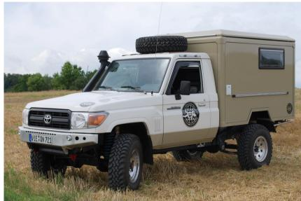
新しくなった顔のHZJ74型ミディアムモデルのシャシにポップアップするリアキャビンを架装したカスタムモデル。エンジンフードの下には1HD-T型が収まっている。
