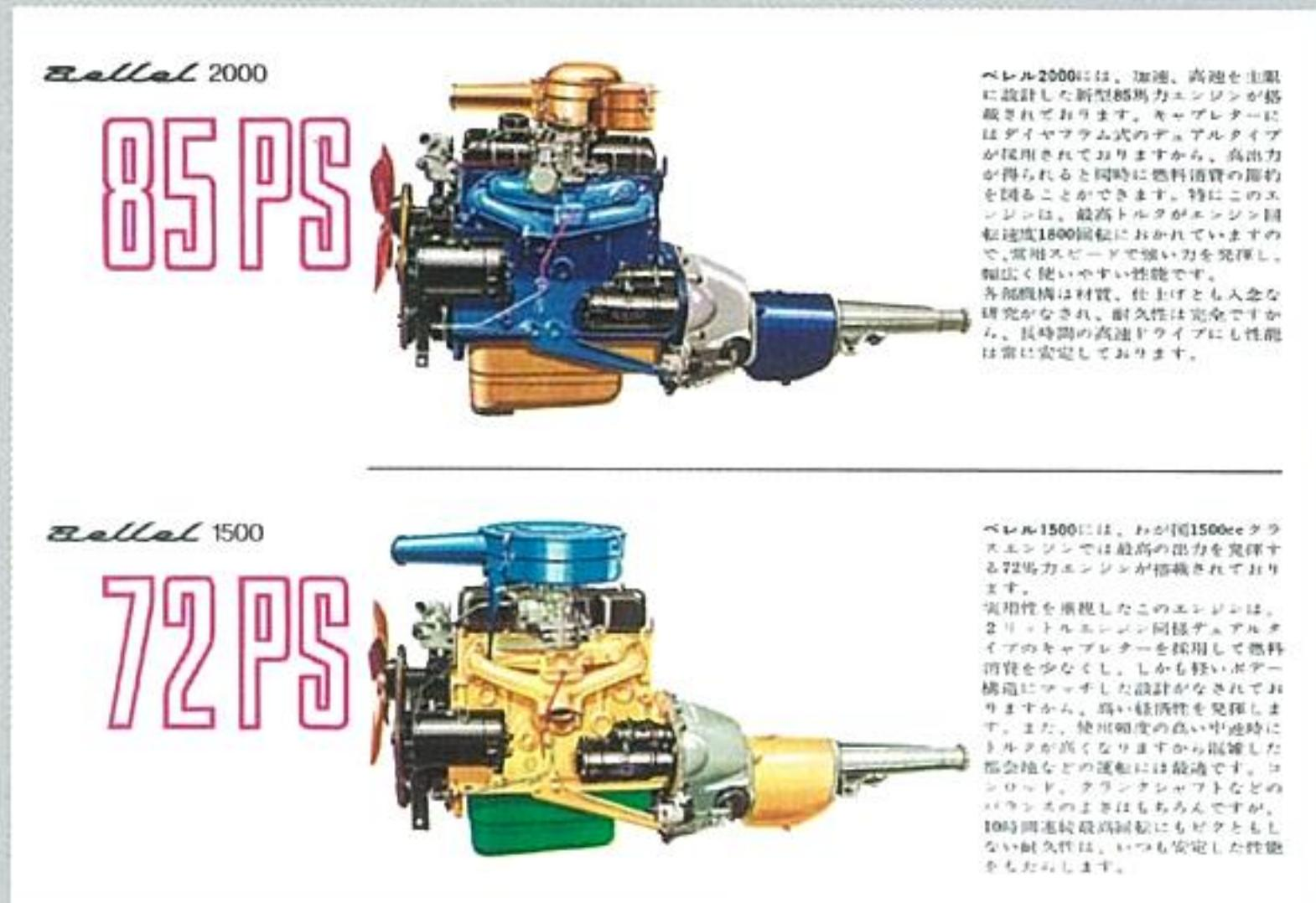
ベレルに搭載された1991cc GL201型直列4気筒OHV 85psと1491cc GL150型直列4気筒OHV 72psガソリンエンジン。GL150型はヒルマンのGH150型をミリサイズで設計し直したエンジンで、それをベースに設計されたGL201型は最大トルク15.3kg-mを1800rpmで発生する、使い勝手の良い低速トルク型エンジンであった。
