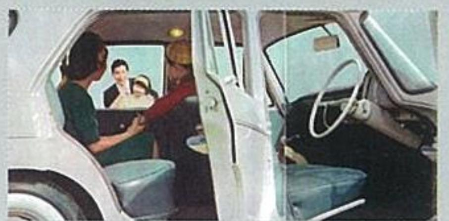
1962年4月に発売されたいすゞベレル2000／1500。いすゞがローヤルラインと称した直線基調のボクシイな造形であるが、1950年代のアメリカ車で一時流行したラップアラウンドウインドシールドを採用したため、フロントドアガラスが極端に小さい。インストゥルメントパネルは実にシンプルで、スピードメーターには外側にキロメーターと内側にマイルのダブル表示が施され、エンジンは2.0ℓと1.5ℓが用意されていた。価格は2000が85.3万円、1500が82.3万円。
