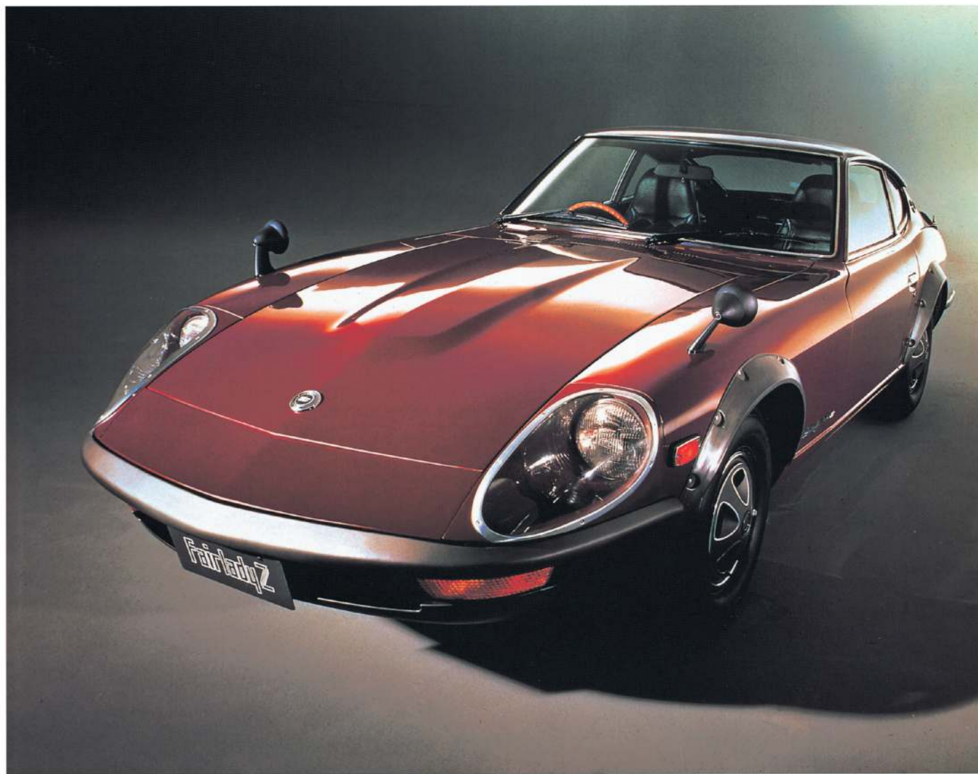
フェアレディ240ZG <Fairlady 240ZG, 1973> 専用のロング(グランド=G)ノーズ(190ミリ延長)と前後にオーバーフェンダー、ヘッドライトカバー等を装備した国内向けモデル。
