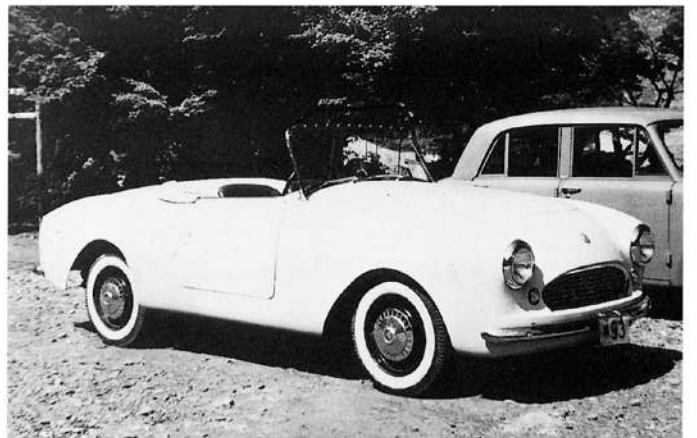
1957年ダットサン A80X <1957 Datsun A80X, considered as a prototype of Datsun Sport S211> ダットサン・スポーツS211発売の前年に作られた試作車で、明らかにそのプロトタイプである。ボディは既にFRPらしい。当時のダットサン210セダンと共通のハブキャップが、この車のシャシーの由来を物語っている。右手に見えるのは210の原型で1955年に登場した110で、背の高さはあまり変わらない。
