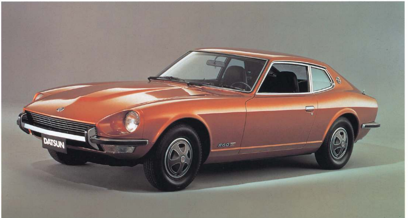
ダットサン260Z 2+2 <Datsun 260Z 2+2, 1974> 写真のモデルはヨーロッパ向けで162ps／5600rpmを発生、アメリカ向け260Zは139ps／5200rpm。
