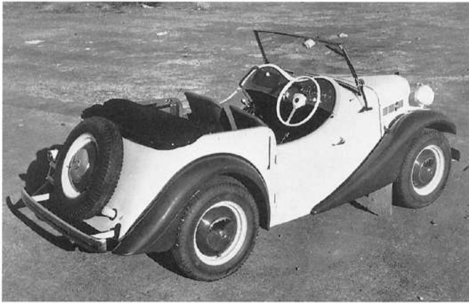
1952年ダットサン・スポーツ DC3 <1952 Datsun Sport DC3> 戦前型のエンジンを860cc 20psに拡大しただけのトラック・シャシーにMG風オープン4シーターを架装した最初のダットサン・スポーツ。1951年12月16日に1号車が完成した。ホイールベース2.15m、車重750kg、3段ノンシンクロ・ギアボックス、マキシマム70+km/h。あまり売れないのでボディを下ろしてシャシーにし、トラックやセダンを架装して売ったところ、何かの拍子に注文が殺到し、下ろしておいたボディを再び生かしたが、今度はシャシーが足りず、戦前型の中古を用いたこともあるという。結局50台の計画で25台売った。
