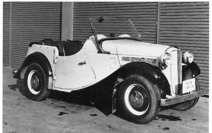
1952年ダットサン・スポーツ DC3 <1952 Datsun Sport DC3> 戦前型のエンジンを860cc 20psに拡大しただけのトラック・シャシーにMG風オープン4シーターを架装した最初のダットサン・スポーツ。1951年12月16日に1号車が完成した。ホイールベース2.15m、車重750kg、3段ノンシンクロ・ギアボックス、マキシマム70+km/h。あまり売れないのでボディを下ろしてシャシーにし、トラックやセダンを架装して売ったところ、何かの拍子に注文が殺到し、下ろしておいたボディを再び生かしたが、今度はシャシーが足りず、戦前型の中古を用いたこともあるという。結局50台の計画で25台売った。
