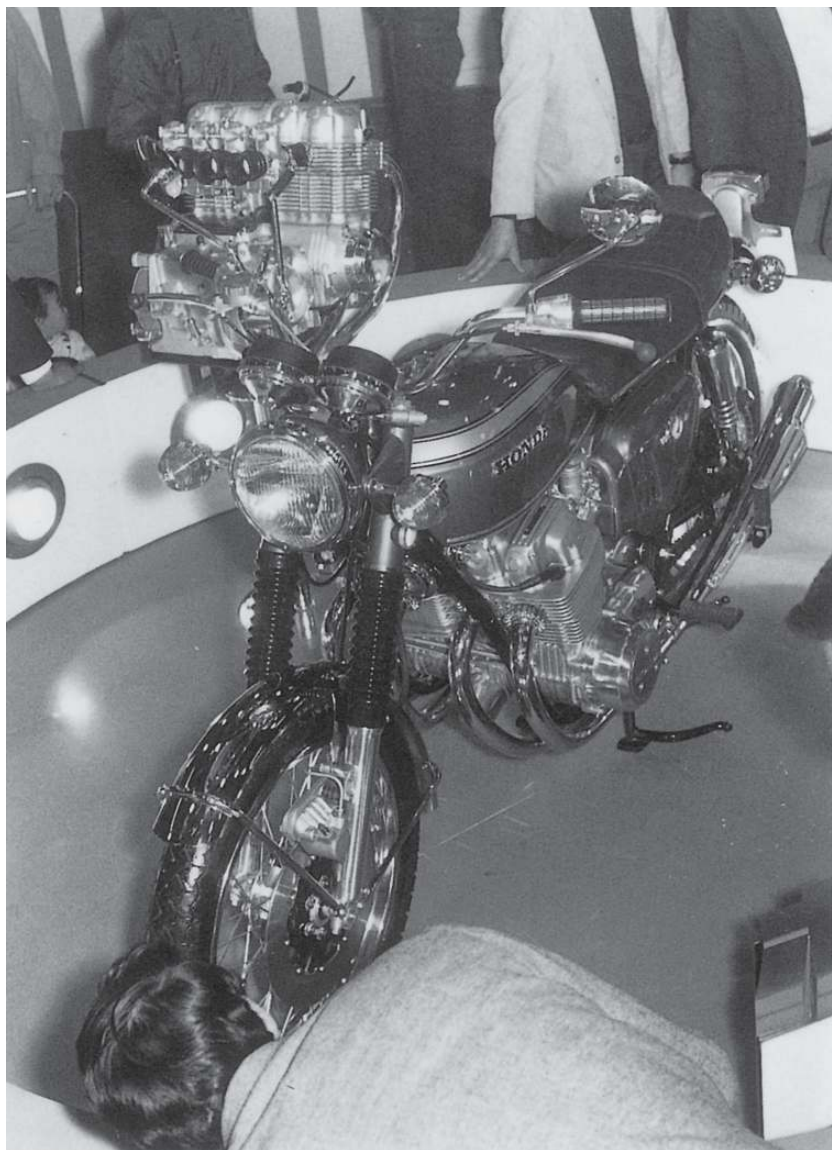
1968年の第15回東京モーターショーで初公開されたCB750プロトタイプ、ターンテーブルの上にエンジンとともに展示された。見学者のほとんどが、かつてない4気筒エンジンとその車体の大きさに感嘆の声をあげた。
