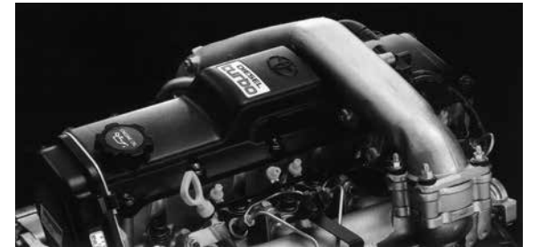
1KZ-T型エンジン。1993年から輸出向けワゴン系に搭載が始まった新開発3リットルOHC直列4気筒ディーゼルトurboエンジンである。国内向けにはEFI化された1KZ-TE型が採用された。
