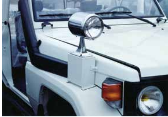
p.234のジブチ向けのモデルと同様にドアを取り外してあり、フェンダー上にリモコンサーチライトを装備する。
