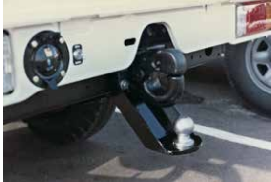
ファイナルメンバーにピントルフックとヒッチボールを取り付けてある。トレーラーソケットも左端に見える。
