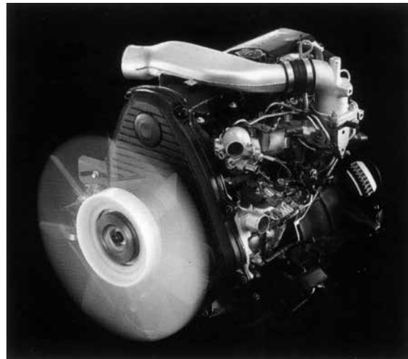
3L型エンジン。2L型エンジンの排気量を拡大した2.8リットル直列4気筒ディーゼルエンジン。
