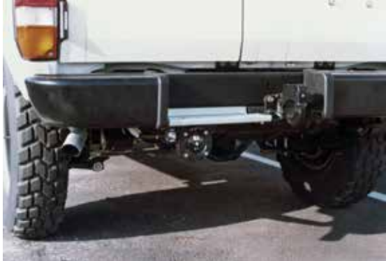
純正バンパーのステップ部分を切り取ってピントルフックを付け、ステップ下に7ピントレーラーソケットを装備する。
