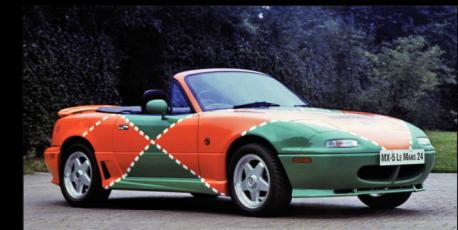
英国で一部にパワー不足の不満の声があり、対策として1990年11月に英國マツダがブロディー・ブリテン・レーシング(Brodie Brittain Racing : BBR)と提携して発売した「マツダMX-5 BBRターボ」。エンジンは158ps/6500rpm、21.3kg-m/5500rpmに強化されていた。
