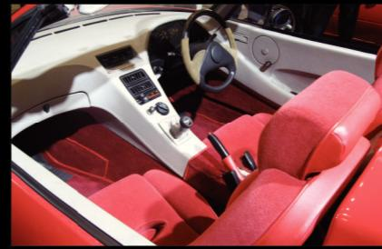
マツダにより、英国のインターナショナル・オートモティブ・デザイン(IAD)に製作を委託して製作された自走可能なプロトタイプ。エンジン・ミッション関係はファミリア、サスペンションやメーター類などはRX-7の部品を流用したFR車で、1985年9月に完成した後に米国のカリフォルニアの市街などを試走。またこの貴重なモデルは、その後マツダによって保管されており現存している。
