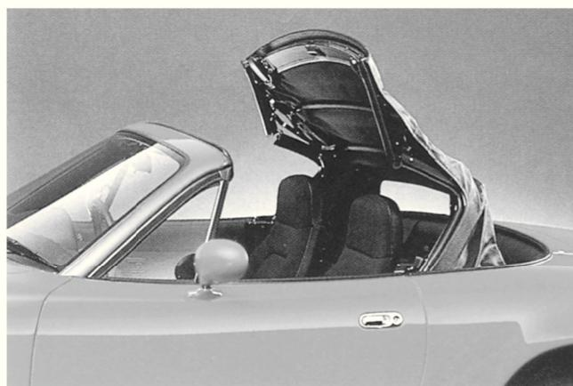
ソフトトップは軽量シンプルでかつ簡単な操作性の実現を狙い、軽量にするためにシンプルでアシスト機構のないリンク構造とし幌はトップシーリングを持たない一枚物とした。操作性については運転席からワンタッチで開閉できるものとし、ビニール製のリアウインドーはジッパーで開閉できる構造にすることによって幌収納時の折れシワの防止、幌装着時の室内換気、補修交換性の向上などに配慮した。
