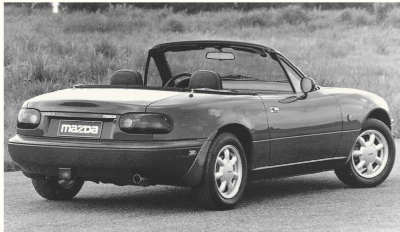
ソフトトップのオープン時にはフレームがスムーズに折れトップクロスが突っ張りもなく上手く追従し、折り畳んだ幌がベルトラインより下にすべて収納される。
