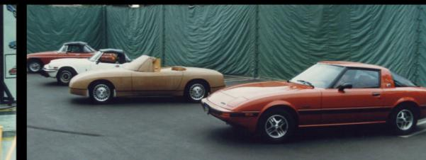
1台目の自走可能なプロトタイプは、全体に腰高だったため、2台目はベルトラインを低くして、LWSとしての特徴的な個性を持たせることがデザインテーマだった。
