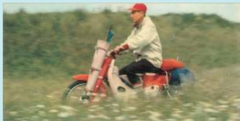
前頁と同時代のスーパーカブ C100 と C105 のカタログ。1960 年（昭和 35 年）12 月 20 日施行の道路交通法で、51cc を越える原付の最高時速がそれまでの 25km から 40km になり、2 人乗り可能、右折方法等の変更によって排気量 51cc 以上の原付二種の人気が高まりをみせていた。また用途が広がるにつれて、スーパーカブの更なる高性能化を望む声もあり、本田はそれに対応して、1961 年（昭和 36 年）8 月に C100 のボアを 2mm 広げた 55cc モデルを C105 として投入した。同時に C100 よりテールランプを大きなサイズに変えて車体色もブルー系からブラウン系に変更している。リアに取り付けるタンデムシートとリアステップ追加分はわずか 2,000 円増に抑えられており良心的な価格設定であった。価格は、C105 が 57,000 円であった。
