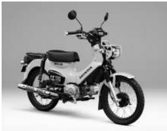
ベースモデルは、スーパーカブ50プロ/110プロであるが、クロスカブ50の車体寸法は、全長のみ20mmコンパクトになっているだけで他は同寸法。この写真のクロスカブ110は、全長では75mm増の1,935mm、全幅も75mm広がって795mm、全高は40mm高い1,090mm。走破性を意識したこのモデルは、最低地上高は157mmと110プロに比べて26mm高く設定されている。価格は、クロスカブ50が270,000円(税別)クロスカブ110が310,000円(税別)であり、スーパーカブ50プロ/110プロに比べてどちらも35,000円高くなっている。
