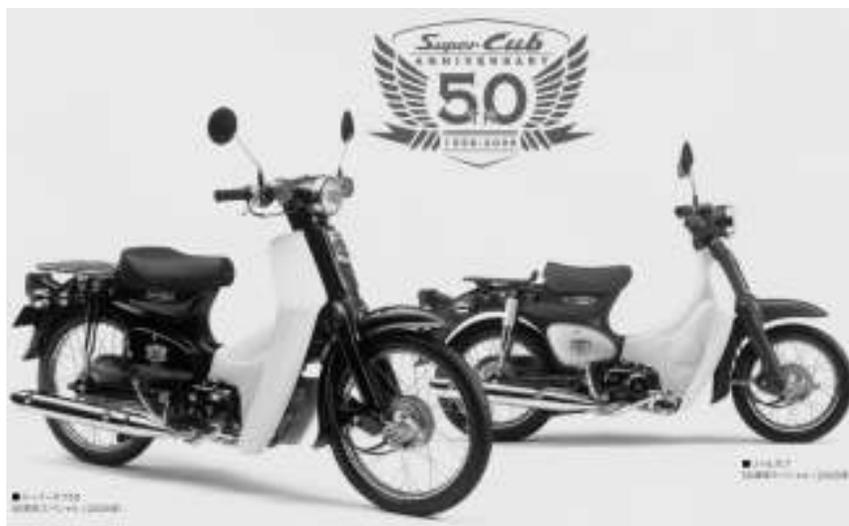
年（平成19年）9月に環境対応した新しいスーパーカブが誕生した。ボディデザインなどには大きな変更は加えられず、クランクケースが従来のシルバーからブラックに塗装が変更されたこと、マフラーガードがパイプ形状から金属パネルに変更されたこと以外、各種の警告ランプが追加された程度に過ぎなかったが、逆にエンジンには数多くの新しい部品や技術が採用されていた。スーパーカブシリーズでは初めて燃料噴射装置（フューエルインジェクション＝PGM-FI）の導入とともに燃料ポンプが装着され、エキゾーストパイプ内蔵の排気ガス浄化装置（キャタライザー）が専用開発されたことで、O<sub>2</sub>センサーなども取り付けられて、二輪車でも課題になってきた排出ガスなどに対策が施された。さらにこの新型エンジンには、効率の良いエンジンとするためオフセットシリンダーや、エンジン内におけるフリクションを低減するために、ローラーロッカーアームや新しいピストンなどが組み込まれ、最高出力3.4ps/7,000rpmであった。他にもエアークリーナ
