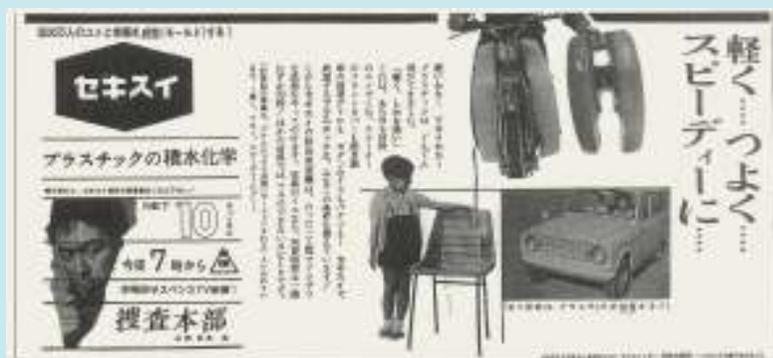
この積水化学による広告は、1961 年（昭和 36 年）4 月 3 日の新聞に掲載されたもので、スーパーカブのフロントカバーがセキスイの射出成型機で作られた製品のひとつとして紹介されている。1 工程で成型できる射出成型機に着眼した本田は、このフロントカバーにハイゼックスという素材を使用した。
