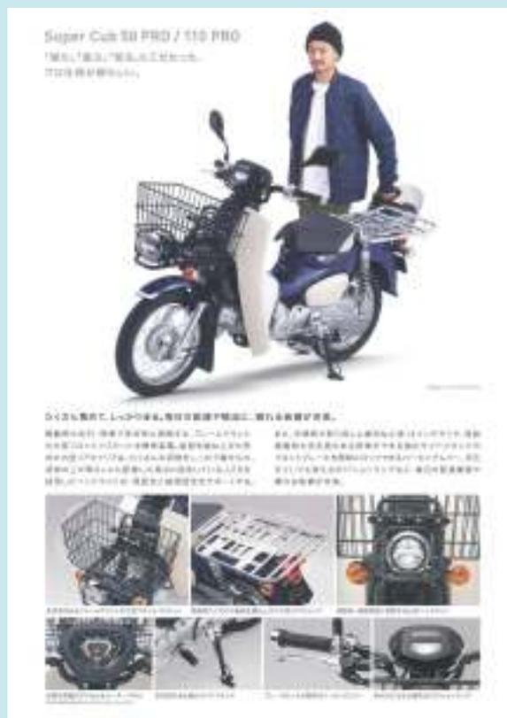
伝統的なスタイルを復活させた新型スーパーカブは、ヘッドライトに加えて、前後のウインカーも丸型となり、メーターも全体のボディフォルムも滑らかな曲線で構成されている。また日本郵便からの要望に対応したという左右取り外し可能なサイドカバーは、右側には電装系部品が収められているが、左側は以前のモデルのように書類などを収納することが可能となり、使い勝手も向上している。長い伝統のあるスーパーカブの独自のスタイリングを継承したモデルともいえる。
