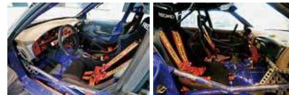
ベース車のダッシュボードを活かしながら、競技用のスイッチ類を配置。メーターパネルも細かい仕様変更が実施されており、最終スペックではアナログの回転数計およびブースト計のダブルメーターに定着した。
