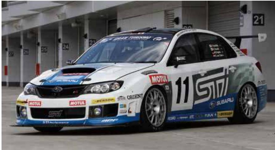
4ドア車両はこれまでのハッチバック形状よりも空力面においてパフォーマンスが高いと言われている。STIはこのGVB型モデルにフロントスポイラーやリヤウイングなど専用のエアロパーツを装着。この結果、ドライバーのひとり、カルロ・ヴァン・ダムは「昨年の5ドア車両に比べると高速レンジでの安定性が増している。ドライビングがマイルドになった」と語っている。実際にその効果は高く、STIは2011年型モデルを武器に念願のクラス優勝を獲得した。
