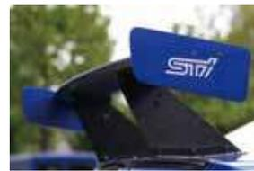
トランクリッドに大型のリヤウイングを装着。もちろん、ほとんどのエアロデバイスがカーボン製で2011年型モデルに対して約20kgの軽量化を実現した。
