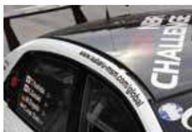
国産モデルとして初めてカーボンルーフを採用したコンプリートカー、WRX STI tSをベースモデルに採用。大幅な軽量化を実現している。
