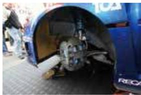
APレーシング製の6ポッドキャリパーを採用。ブレーキパッドは24時間レースで豊富な実績を持つエンドレス製が採用された。
