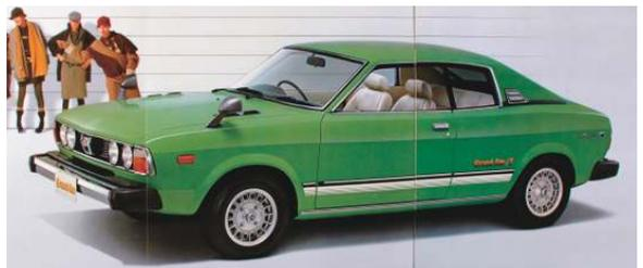
レオーネの5マイルバンパー比較。右のモデルに装着されている5マイルバンパーは、5マイル(8 km/h)以下で衝突した際の衝撃吸収と復元、ヘッドランプなどの破損を食い止めるために、1974年モデルイヤーから適合されたアメリカの安全基準をクリアするための対応。当時は板金バンパーであったためバンパー本体がボディから大きく突出することになり、5マイルバンパー装着車のほうが格好悪くみえる形となった。
