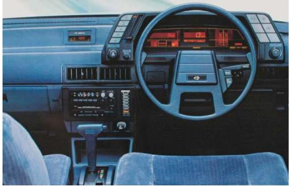
SUBARU レオーネ最終型となる3世代目。ボクシーなデザインがアメリカでは好評で、当時は日本よりアメリカで収益を獲得していた。外観デザインと共通のパネリック(平面的)なインテリアデザインは、スイッチも皆タッチ式。デジタルメーターも採用した。パートタイムAWD+水戸対向1800ターボエンジンを採用し全天候の安全走破性を獲得していた。
