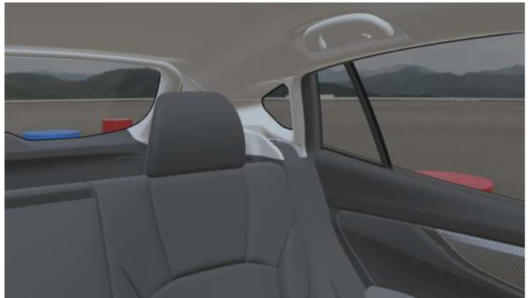
ドライバーのアイポイントから後方の直接視界。社内基準の1メートルポールもしっかり見えている。
