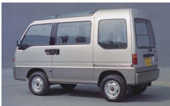
サンバーの樹脂製アウター&インナーダミーモデル。当時は試作車ができる前に、デザイン部でフルサイズの樹脂モデルを制作した。この後、軽自動車の規格諸元が変わり全幅を広げる大改修を実施することになる。
