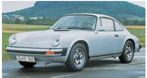
5マイルバンパーの装着でもとのデザインの良さを崩さずにうまく処理して成功した例もある。ポルシェ911である。右の写真が5マイルバンパーの2代目の930型。クラシカルな、ボディと同色の細身のバンパーだが、デザイン的には両端に衝撃吸収に見える化した黒い蛇腹をアクセントとした大型ウレタンバンパーに変更。力強い走りの表現に加え「安全感」も取り込み拡販を成功させた。
