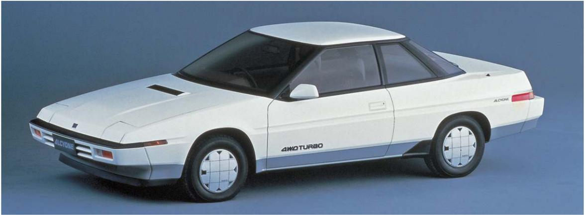
レオーネのシャシーとエンジンを使ってスペシャルティクーペボディを纏ったアルシオーネ。スケッチからそのまま飛び出したような独特のデザインで、コマーシャルではアバンギャルドと宣伝した。ピラーをブラックアウトし航空機のcockpitイメージを具現化。FFでありながらCd:0.29を誇る空力性能を実現。リトラクタブル式ヘッドランプや、ドアハンドルにフラップを付け、コンシールドワイパーを採用するなどにより空力性能を高めている。まさに、中島飛行機のDNAが生み出したデザイン。
