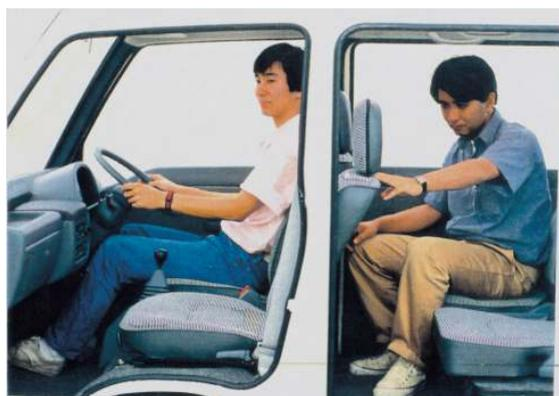
インテリアのモック検討。前席が石井、後席がインテリアの新井敏一担当。ドアとリヤクォーターウィンドーを下げた視界を室内から確認し、エクステリアにフィードバックさせた。
