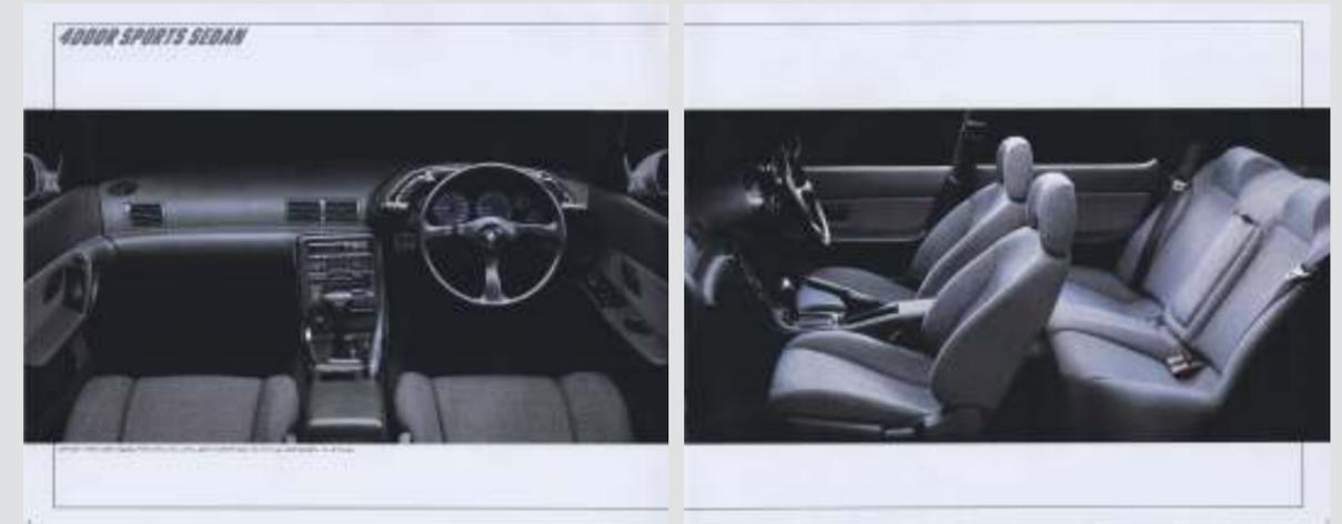
スポーツカーの cockpit にいるような満足感と興奮を感じさせるインテリアを目指したという、黒とグレーを基調とした機能的でシンプルな運転席と室内。着座位置は先代より50mm低く、ドライバーを包み込むようなインストゥルメントデザインが採用されている。
