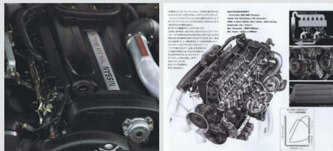
GT-Rの心臓ともいえるRB26DETT型2568cc直列6気筒DOHC 24バルブ インタークーラー付きツインターボ280ps/6800rpm、36.0kg-m/4400rpmエンジン。各部の剛性強化のほか、レスポンスにこだわり6連スロットルチャンバー、8000回転という高いレブリミット実現のため直動式軽量インナーシム型バルブリフター、耐熱性向上のためナトリウム封入中空エキゾーストバルブおよびステンレス鋼エキゾーストマニホールドなどを採用している。ターボはコンプレッサー側にギャレット製T3型、タービン側にT-25型を組み合わせ、タービンローターはメタルに対して慣性モーメントを約40%低減できるセラミックとしている。開発段階では310psを発生したが、市販車には強力すぎるのでデチューンして280psにしたという。
