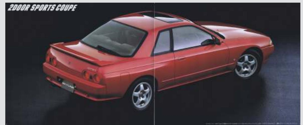
セダンと同時に発売された8代目スカイライン 2ドアスポーツクーペ。運動性能を重視したクーペの全長はセダンよりもリアのオーバーハングを50mm つめて4530mmとしており、先代より130mm短くなっている。全高は1325mmで先代のクーペより40mm低くなった。写真のモデルは、2WDでは最上級グレードのRB20DET型ターボ215ps+5速MTを積むGTS-t Type Mで、価格は238.5万円。4速E-ATを選択すると9.7万円高であった。リアスポイラー、サンルーフはオプション。
