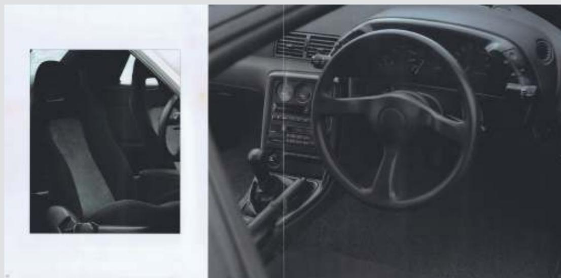
光物を一切省いた運転席。正面には専用6連メーター、センターコンソールには3連サブメーター(ブースト計、電圧計、油圧計)がセットされ、エアコンもコンプレッサーの消費トルクを低減した電子制御アクティブフルオートを装着、ホールド性を徹底的に追求したモノフォルムパッケージシートが採用された。ステアリングホイールの形状もテストコースで玉成されたという。
