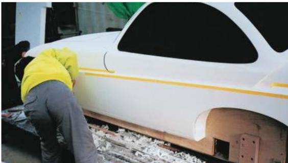
修正図面によりサイドパネル断面を削る。
