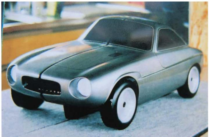
安藤純一さんが中学時代の記憶をもとに作ったパブリカスポーツのスケールモデル。復元プロジェクトのきっかけとなった。このクレイモデルは左側半分だけ作成して鏡で一体に見せるハーフミラー・モデル。
