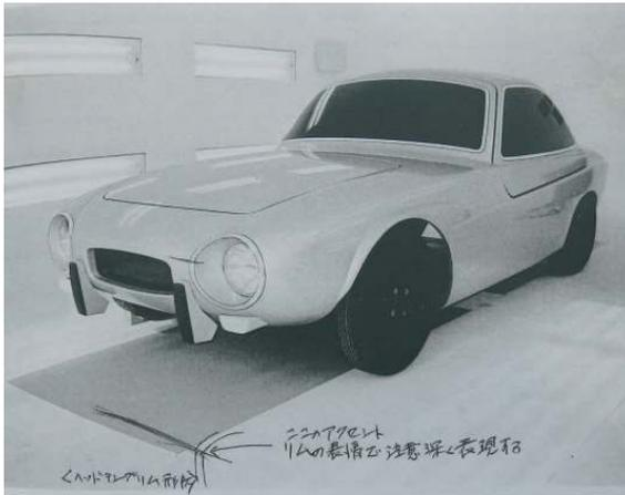
検討の結果、ヘッドライトリムのアクセントポイントが曖昧な形状であることが判明、修正する。
