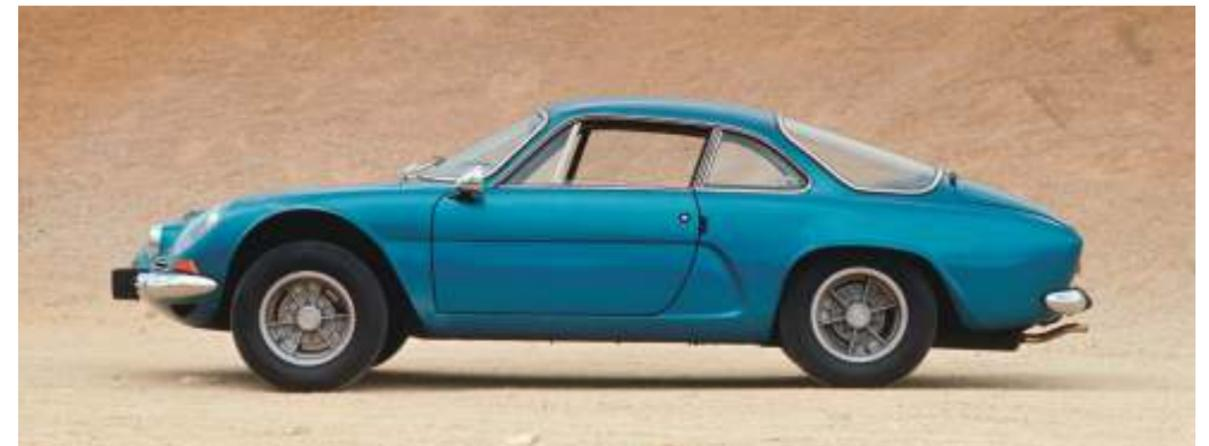
A110には初期には4座やカプリオレボディもわずかに存在したが、メインはこのベルリネット。ベルリネット（イタリア語でベルリネット）といえば、アルピーヌがフェラーリというイメージもある。A110ベルリネットは、わずかに下降しながらまっすぐテールまで伸びるベルトラインが、初代のA106とは異なる。ルノー8のエンジンを積むため、リア部分はA108より若干伸びている。ホイールベースは4CVと同じ2100mmで、車体は極めてコンパクトで低く、ひきしまったボディラインが、徹頭徹尾スポーツ用の自動車としての雰囲気を出し出す。A110の車体は後半に向けて絞り込まれたデザインだが、後期のモデルはリアフェンダーがふくらみ、足腰の強さも感じさせる。これは1975年6月に撮影されたモデル。
