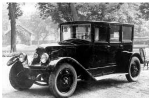
これは2120ccの10CVの1924年型で、タイプKZと呼ばれた。いわゆるセダントタイプの車体で、古風なところも残しているが十分近代化されており、なによりいかにも高品質なつくりを感じさせる。
