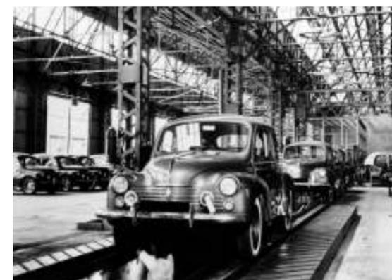
日野ルノーは1953年に組立生産が始まった。当初はフランスから部品を輸入してのノックダウン生産だったが、しだいに国産化率を上げるようになった。その経験をもとに日野はリアエンジンのコンテッサを独自に市販化した。写真は初期の日野ルノーで、本国の初期型と同様のフロントデザインが見てとれる。
