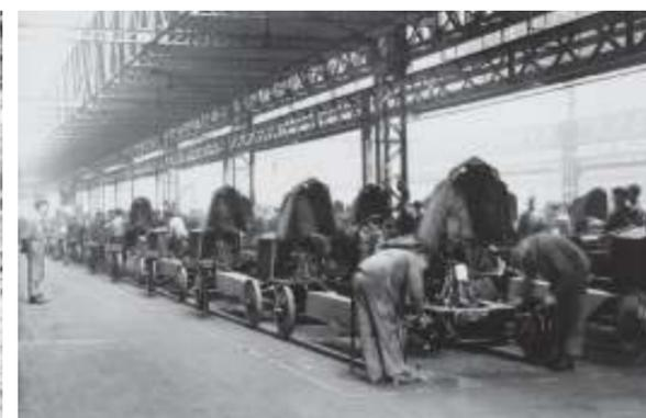
1924年のビヤンクール工場の組立ライン。戦争を経て、ルノーでも大量生産が始まった。組み立てているのは10CVで、この年の生産台数は10CVが約8000台で、6CVはその約2倍だった。
