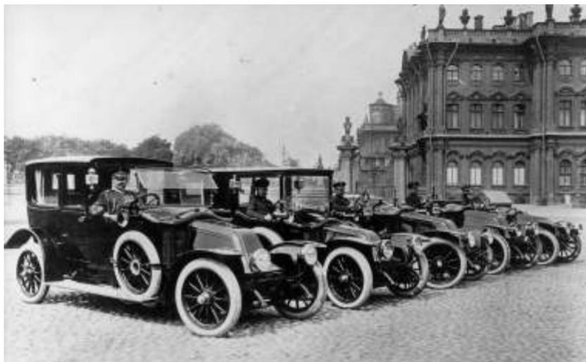
レースでの活躍もあってルノーの名声は早くも海外に知れ渡った。これは1912年にロシアのサンクトペテルブルクの宮殿前で撮影されたルノー高級車の一団。ロシア革命前の王室で使われた。ラジエターをスカットル前に置くルノーのフロントノーズは特徴的で、アリゲーターとかクロコダイルなどと呼ばれた。この頃は既に6気筒までがラインナップされていたが、ここに並んだクルマも、ボンネットの長さに長短がある。一見流線型のこのボンネットのカーブ部分はなかなか優雅な趣きがある。
