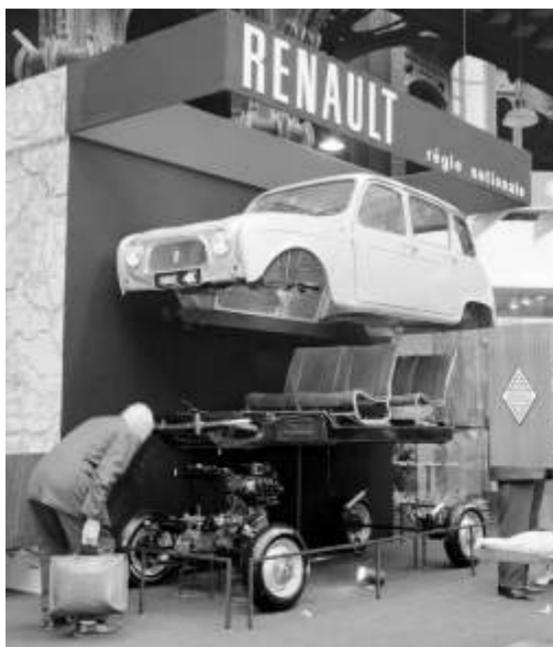
4は、スガン島で1961年8月に生産開始され、10月のパリ・サロンで初公開された。足回りとパワートレイン、プラットフォームシャシー、車体を分割した展示だった。4は、戦後に普及したモノコックに近い車体だが、ボディ上屋を自由に造形できるようプラットフォームシャシーが仕立てられた。リアサスペンションの左右タイヤをまっすぐ結ぶ棒が、トーションバー・スプリングで、写真では1本に見える。シートの骨組がシンプルなパイプできているのがわかる。このモデルはリアクォーター部分がガラス窓の4L。革のかばんを持った紳士が、前輪駆動のフロント部分を覗き込んでいる。4気筒エンジンの前方にデフヤギアボックスが配置されているのがわかる。
