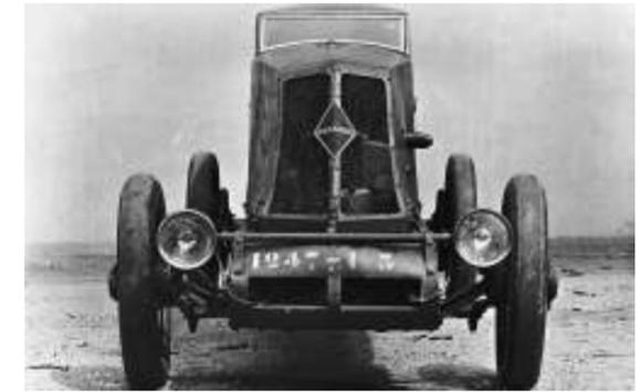
1926年の40CVタイプNMスペシャルの正面。単座で、軽量化や全面投影面積の配慮のため、車幅が狭い。注目すべきはルノーとして初めて冷却のためのフロントグリルが設けられていること。バンクのオーバルコースを左まわりに周回したためか、向かって左側のタイヤのほうが摩耗しているように見える。
