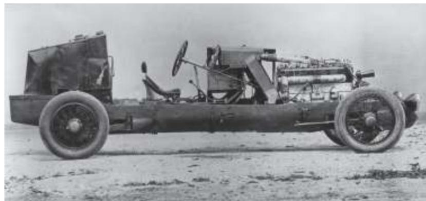
下：1926年の40CVタイプNMスペシャルのシャシー。40CVは市販車の場合ホイールベースは3800mm（短いほうで）、6気筒エンジンは9120ccあった。長大なシャシーに単座が組み込まれているが、シートバックがほとんどない文字どおりの腰かけで、ドライバーの目の高さがハンドル上縁と同じくらい、後部の250リッタータンクの上辺がほぼルーフラインと思われる。ラジエターは、戦前以来のルノーこだわりのエンジン後方配置だが、後傾している。車体下部も空気抵抗軽減のためスムーズ化されている。絶対的には巨大な重量級であるが、低さを極めた車高、徹底した軽量化、訓練されたピット作業など、現代のルマンを戦うマシンなどに通じる世界のものと感じられる。
