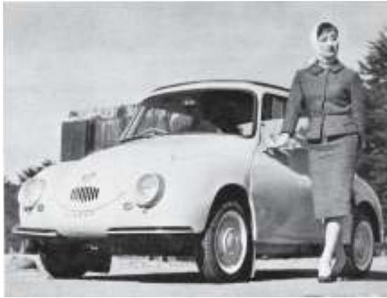
日本の大衆向けモータリゼーションの口火を切ったスバル360。四輪独立懸架、RR駆動方式はそのままサンバーへと引き継がれた。
