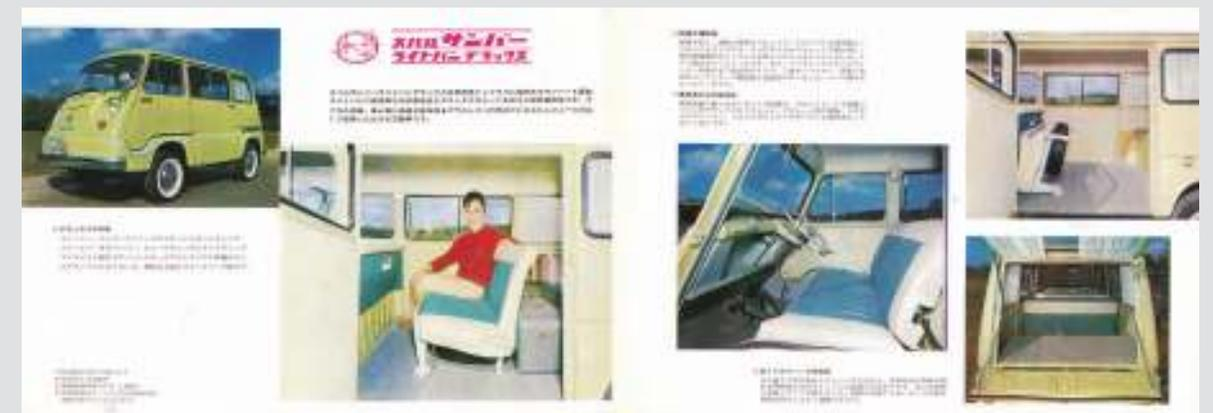
エクステリアでは、ウインドーとウェザーストリップのステンレスモールディング、クロームメッキのバンパー、ホイールキャップとタンクキャップ、ダイキャスト製のドアハンドルで高級感を増している。インテリアでは、フロントシートを当時の乗用車的なベンチタイプとした。また、スペアタイヤをリヤシート下部に移し、前方荷物棚を広くラジオが取り付けられるようになっているのも変更点だ。
