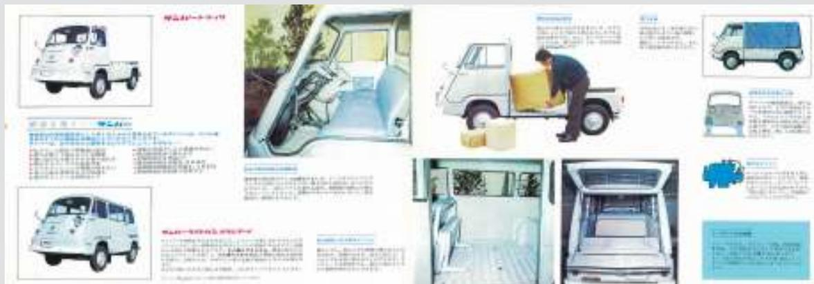
初のマイナーチェンジは居住空間の改善を中心に行なわれた。サンバートラックは、シートをライトバンデラックスと同様のベンチタイプとした。バックミラーを両側フロントパネルにしたのも、その一環といえる。マイナーチェンジで後面ドア付きの4ドアがラインナップに加わった。スペアタイヤが助手席足元にあるのがよくわかる。
