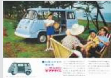
エンジンはスバル360と同様の強制空冷2サイクル356ccを搭載した。その積載能力は当時特筆されるもので、実際の最大積載量350kgを大きく超える「1300kgの荷物を積んでも走る」というユーザーからの声なども聞かれたという。軽量でRRという駆動方式から登坂能力にも長け、満載時でも14.5°の坂道を登る能力を与えられた。強制空冷エンジンは回転を上げることで冷却されるため、当時、自動車全般の悩みのたねであったオーバーヒートにも強かった。
