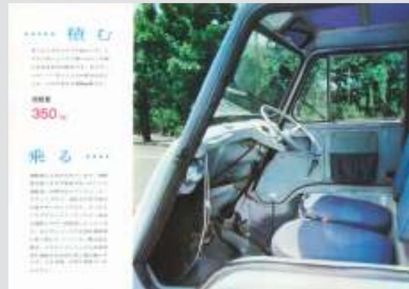
サンバーの大きな特徴となったのは、キャブオーバースタイルであることと、リヤエンジンであること。これにより低床化もできた。モノコックフレームの可能性もあったが、過積載も考え中空角材を用いたラダーフレームにしたことにより強度も高くなった。この方式は6代目サンバーまで続くことになる。
