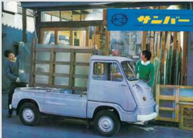
1962(昭和37)年、初期型の運転席のみのサイドミラーから両側サイドミラーにマイナーチェンジされたサンバー。四輪独立懸架は、「豆腐の角が崩れない」という逸話を生むほど荷物への影響が少なく、良好なものだった。事実、カタログにも見られるようにガラスなど壊れやすいものを運ぶ用途にサンバーは大いに用いられるようになる。
