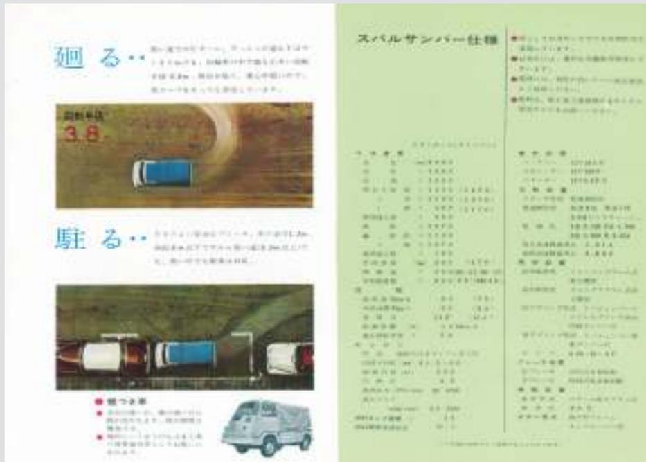
サンバーの長所は、エンジンがすでに定評のあるスバル360と共用だったこと、荷台の広さが軽四輪トラック最大となる1400mmとなったことで、さらに荷台床面地上高は350mmと低く、ボディ構造がラダーフレームで強度が高かった。それはあえてスバル得意のモノコック構造としなかったことに起因したといえる。
