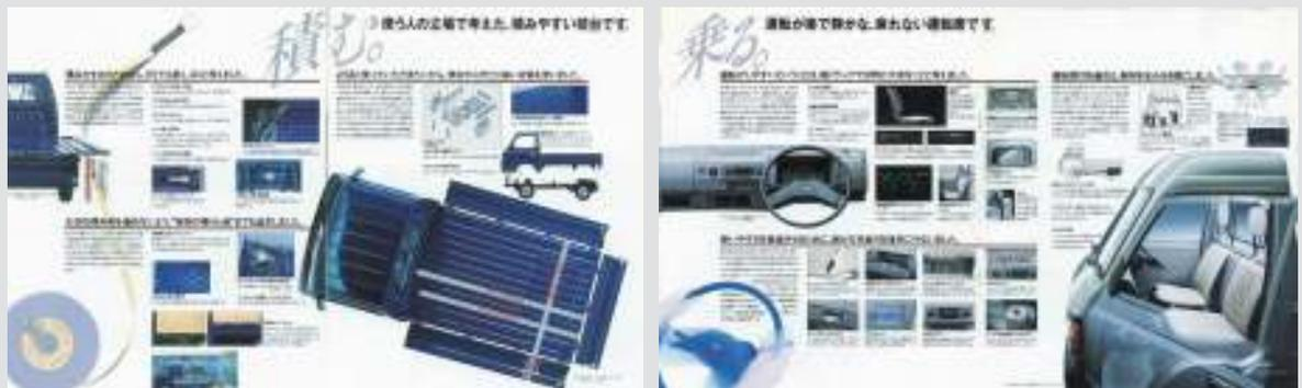
荷台の低さに徹底的なこだわりを見せてきたサンパートラック。2WD/4速車の荷台は、610mm。2WD/5速車は620mm、4WD標準ルーフSTDは670mm、その他の4WD車は655mmとなっている。それぞれがミリ単位で使いやすさを追求したとカタログにはある。その他、リヤゲートチェーン、ワンタッチ式ゲートラッチ、作業灯など働くクルマとしての魅力がアップしている。
