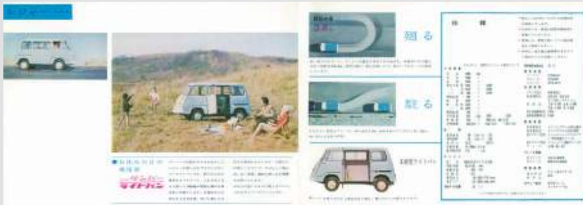
積載性だけでなく、走行性能の高さがサンバーの特徴だった。これは先述の通り、基本的なコンポーネントをスバル360から受け継いでいることも大きい。前はトレーリングアーム式、後ろはスイングアクスル式の四輪独立懸架。リアエンジンに加え、操縦性の良さは、低床化による低重心となったことが一役買っていた。当時の『モーターファン』誌では「ロール角は乗用車であるスバル360よりも少ない」などの記載もある。
