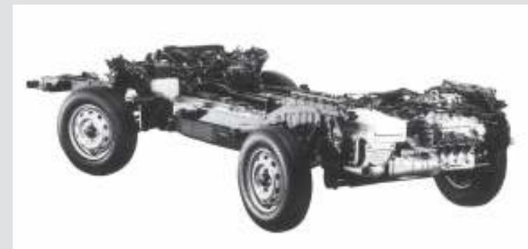
6代目サンバーのRR方式&シャーシフレーム構造
