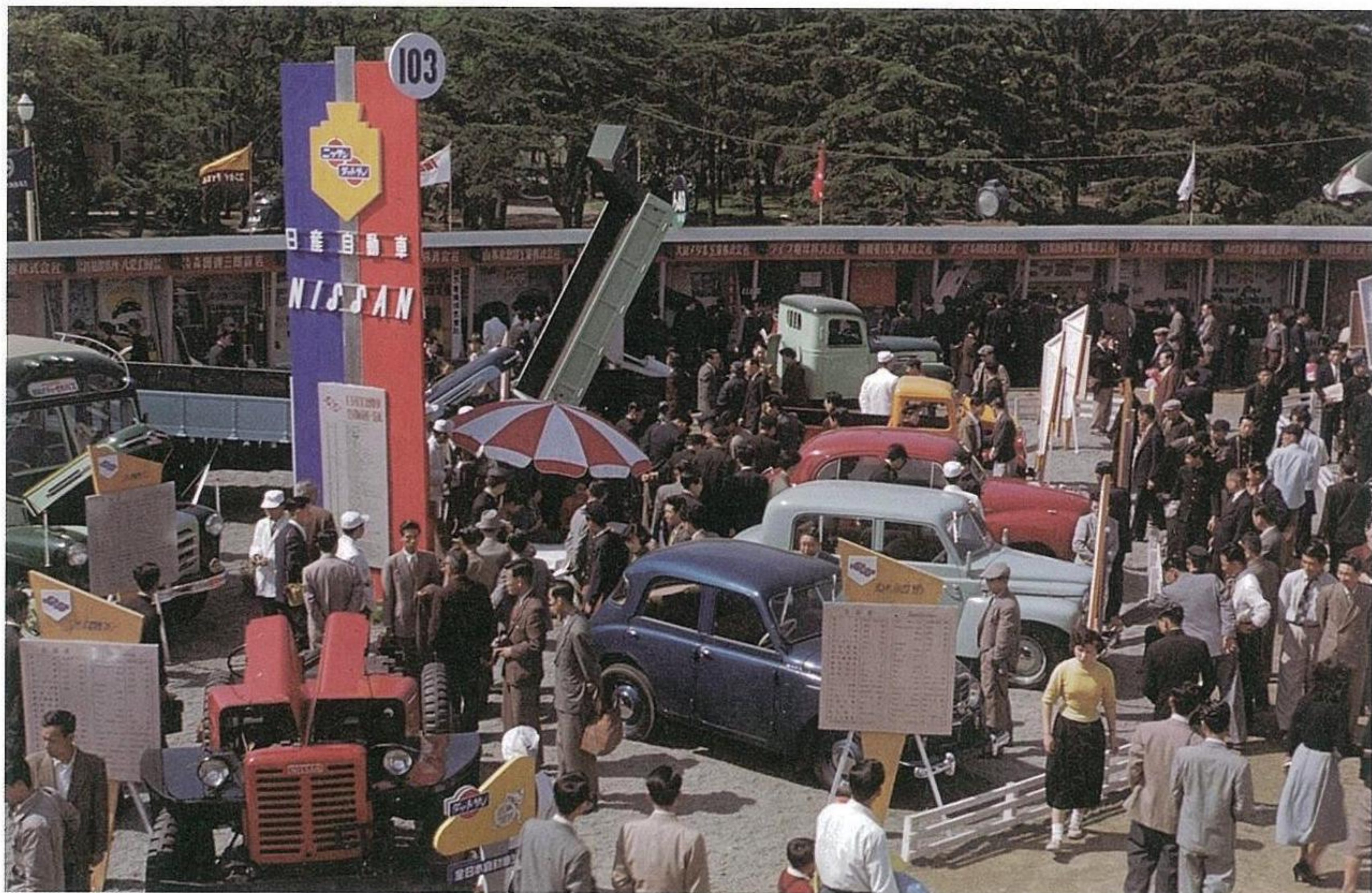
ダークブルーの乗用車はダットサンデラックスセダン(DB-5後期型)。それから数えて4台目に見える黄色いキャブ(運転台)のトラックは、戦前型ボディに、改良型エンジンを載せて生産されたダットサントラック。エンジンは乗用車と同じサイドバルブ方式 860cc、25馬力、最大積載量 600kg。ダットサンセダンとトラックはエンジンを含む基本シャシーを共用していた。「モーターファン」1954年6月号に掲載された同年4月15日時点の東京店頭渡し価格は、ダットサンデラックスセダン 85万円、同スリフトセダン 82万円。
