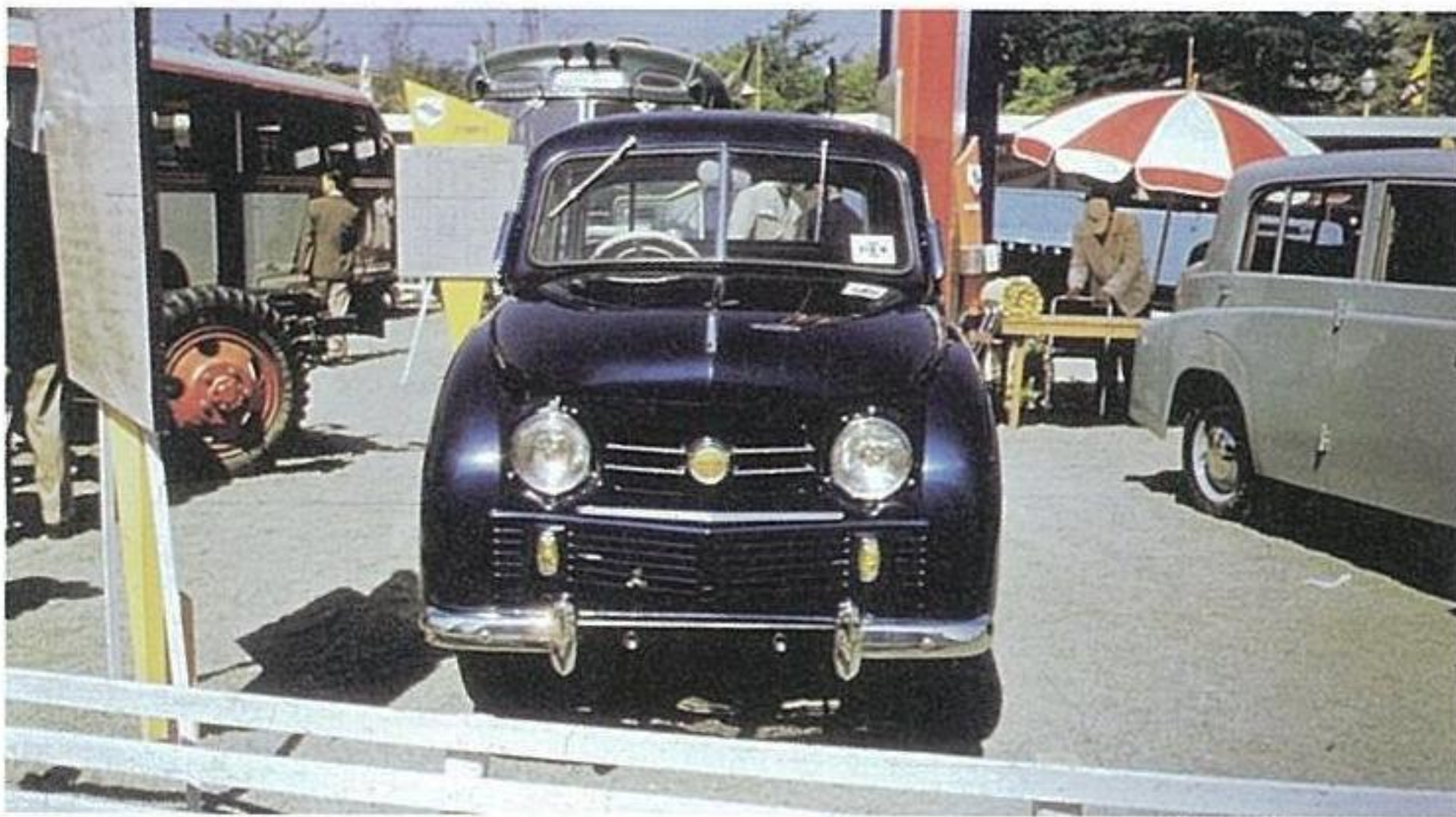
ダットサンデラックスセダン(DB-5後期型)。最初のDB型は、アメリカのコンパクトカーであるクロスレイのスタイルを参考にした、フラッシュサイドボディの2ドア2ボックスセダンとして1948年に登場した。DB→DB-2→DB-4と発展した後、1953年1月に4ドア化を含む約350箇所の改良を受けてDB-5となった。展示車は1954年1月にフロントグリルの意匠変更と、サイドまで回り込んだリアウィンドウを採用したDB-5後期型。DBシリーズのエンジンはすべてサイドバルブ方式の水冷4気筒で、DBが15馬力/722cc、DB-2・DB-4が20馬力/860cc、DB-5が25馬力/860cc。全長3805、全幅1480、全高1560、ホイールベース2150(各mm)。4人乗り。ショーの後、7月に小変更されてDB-6型となり、翌1955年1月にダットサンセダン(110型)に生まれ変わった。
