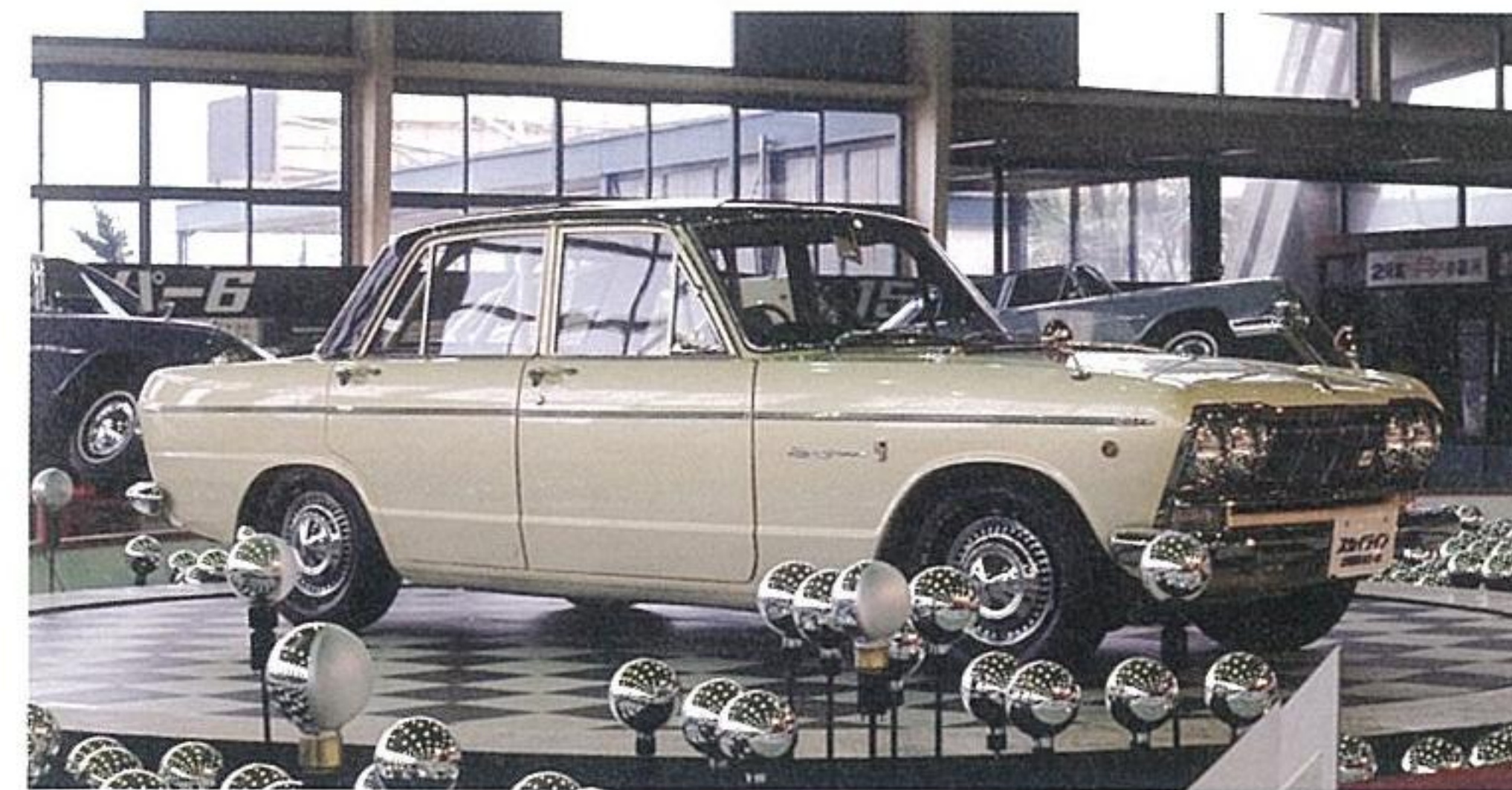
9月にプリンススカイラインのスポーツモデルに、105馬力エンジン搭載の廉価グレード2000GT-Aが追加され、それまでの2000GTは2000GT-Bに車名が変更された。後方の傾けられた2台はグロリア。
