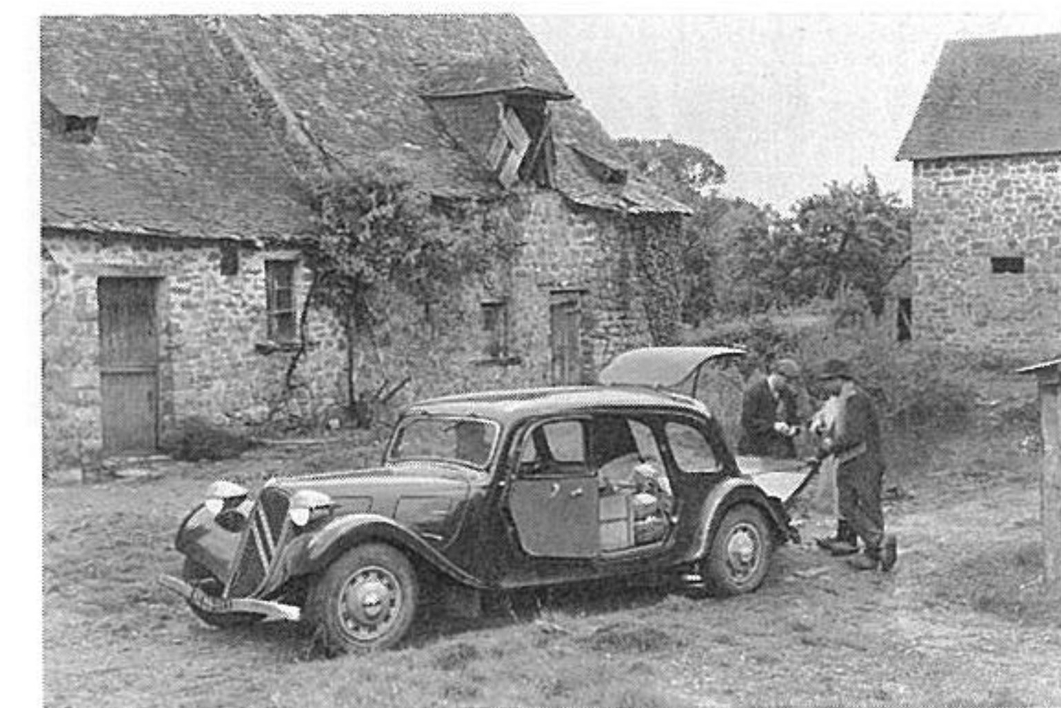
トラクシオンアヴァンのロングボディのモデル。これは後部がハッチで開くタイプ。2CVと同じで、田舎での生活でも重宝されそうな多用途性があった。FFなので床が低く、荷物を積みやすかった。
