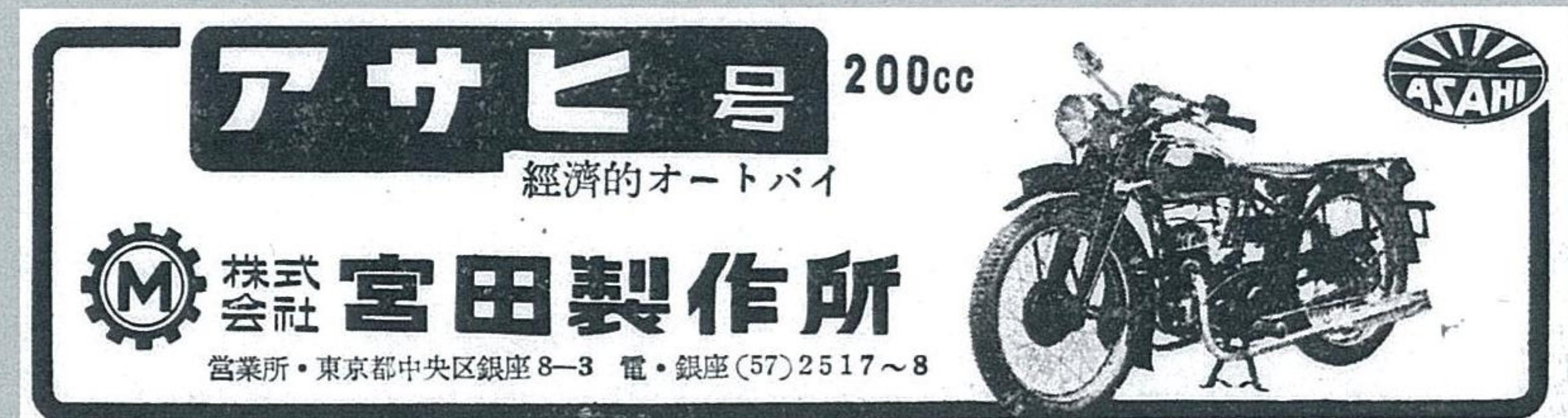
1935年に製作したアサヒ号は英國のコペントリーイーグルを模したもので、おそらく鋼管は兵器用に使われたため鋼板プレス板の車体を持った、自転車の技術を活かしたとはいえないモデルだった。エンジンも英ビリヤス製を模した2サイクル175ccだったが、第二次世界大戦後の1945年にはD型200ccに排気量アップされ、車体も鋼管製になったがフロントフォークは設計ができなかったのか、そのままであった。販売事務所が戦前の神田仲町(現在の外神田3丁目)から銀座8丁目の外堀通りに移転した。戦後復興の渦中でもあり、高価な二輪車の購入者のほとんどが米駐留兵だったとされる。性能は空冷2サイクル単気筒196cc、3.0ps/4000rpm、3段変速、車重120kg。出力は実用馬力であり、AA型も3.0psが実用馬力だったが、ガソリンも配給時代品質も良くなく馬力も出せない状況で性能も大差なかった。
