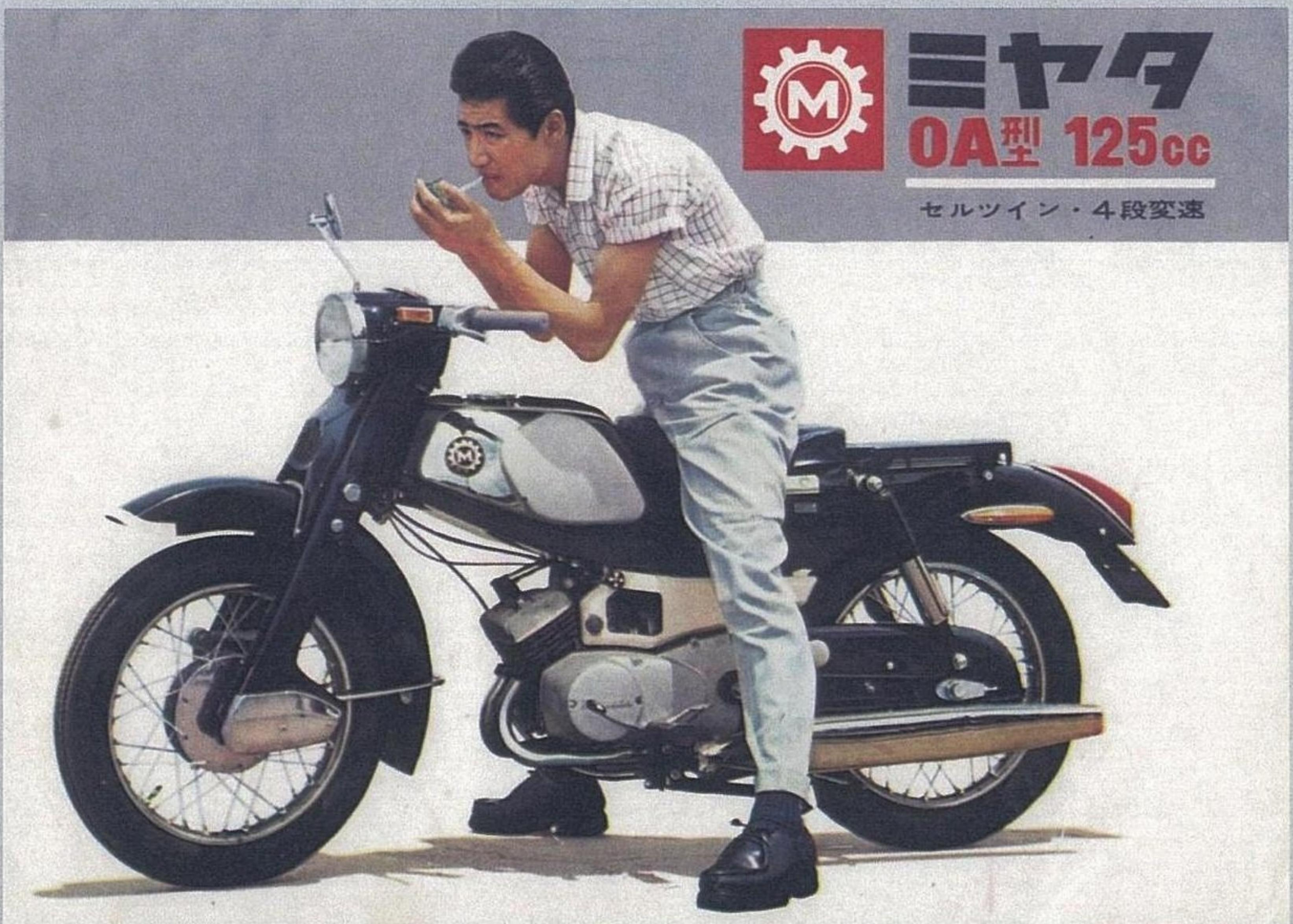
松下電器の参入で、戦前から続いたオートバイの自社製エンジン搭載が打ち切られ、エンジンは他の自転車メーカー、特に山口自転車のスーパーツイン用に設計された東京・立川のガスデン製を購入して、独自の車体に搭載することになった。もっとも車体も倒産したばかりの山口同様の鋼板プレスモノコック構造で、フロント部分やフェンダーなどのデザインに特徴がみられた。ガスデン製エンジンは供給元のガスデンFMCや東京では福生の片倉自転車のシルク号や、名古屋の伊藤機関工業のIMCなどにも搭載されていたため個性に乏しく、ミヤタも1962年5月をもってオートバイ生産から撤退を決定、国産最古の二輪車メーカーの歴史を閉じることになる。
