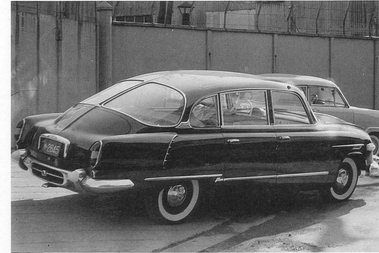
1959 タトラ603 4ドア・セダン（空冷V8 リア・エンジン）
