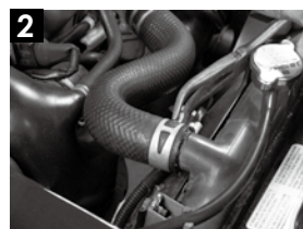
2 プライヤーでクランプを挟みラジエター側のアッパーホースを外す。
