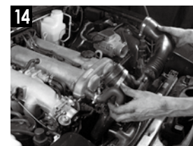
14 3カ所のクランプと1カ所のボルトを外すと、エアダクト Assy で外れる。
