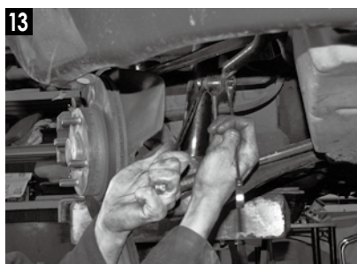
13 スタビライザーコントロールリンクを37～55Nmのトルクで締付ける。このトルクは上下ともに同じだ。
