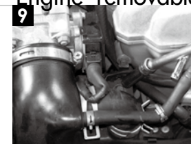
9 エアフロ以降のインテークホースを固定しているボルトは、これ1本だけ。
