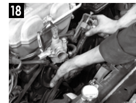
18 P/S駆動ベルトを引き上げるとポンプが内側に動き、駆動ベルトが外れる。
