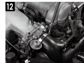
12 スロットルボディ側のクランプもボルトで留められている。こちらも外す。
