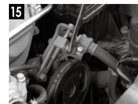
15 ベルト調整の要領でP/Sポンプ駆動ベルトを外すために、固定ボルトを緩める。
