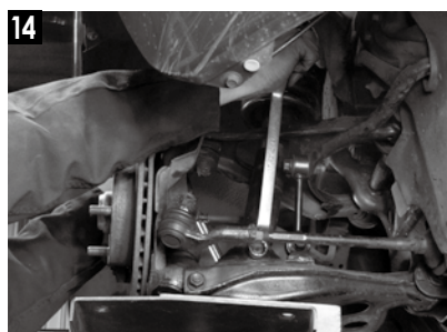
14 ロアアーム上のダンパーブラケットの貫通ボルトを74～95Nmのトルクで締付ける。
