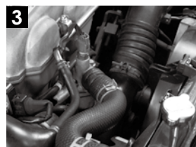
3 ラジエター側、サーモスタット側の双方の固定クランプを外す。
