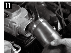
11 簡単に外れるが、流量計測以降なので2次空気の吸い込みには要注意だ。
