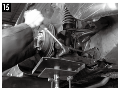
15 ロアアームのボディ側（フロント）も緩めた場合は74～97Nmのトルクでマーキング通りに締付ける。
