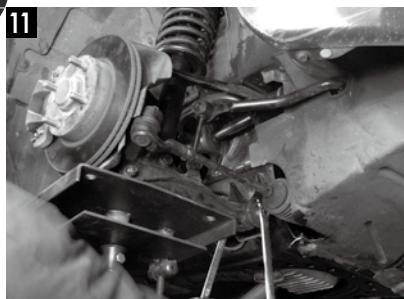
11 ブッシュが捻じれることなく正常な状態で納まるために、各部締付けは1Gをかけた状態で行なうこと。
