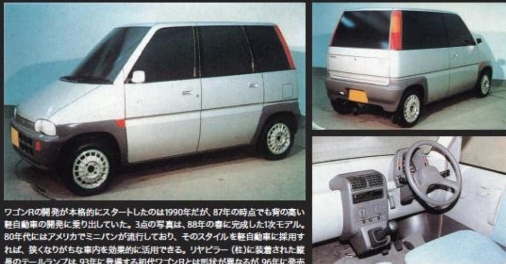
ワゴンRの開発が本格的にスタートしたのは1990年だが、87年の時点でも背の高い軽自動車の開発に乗り出していた。3点の写真は、88年の春に完成した1次モデル。80年代にはアメリカでミニバンが流行しており、そのスタイルを軽自動車に採用すれば、模倣なりがちな車内を効果的に活用できる。リヤビラー(柱)に装着された長いテールランプは、93年に登場する初代ワゴンRとは形状が異なるが、96年に発売されたステップワゴンなどが同じ手法を用いている。
