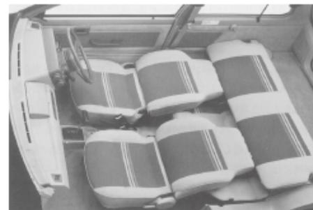
4ナンバー車ではリヤシートが前寄りに付く。フロントシートのバックレストを倒すと、リヤシートの座面が離れる。
