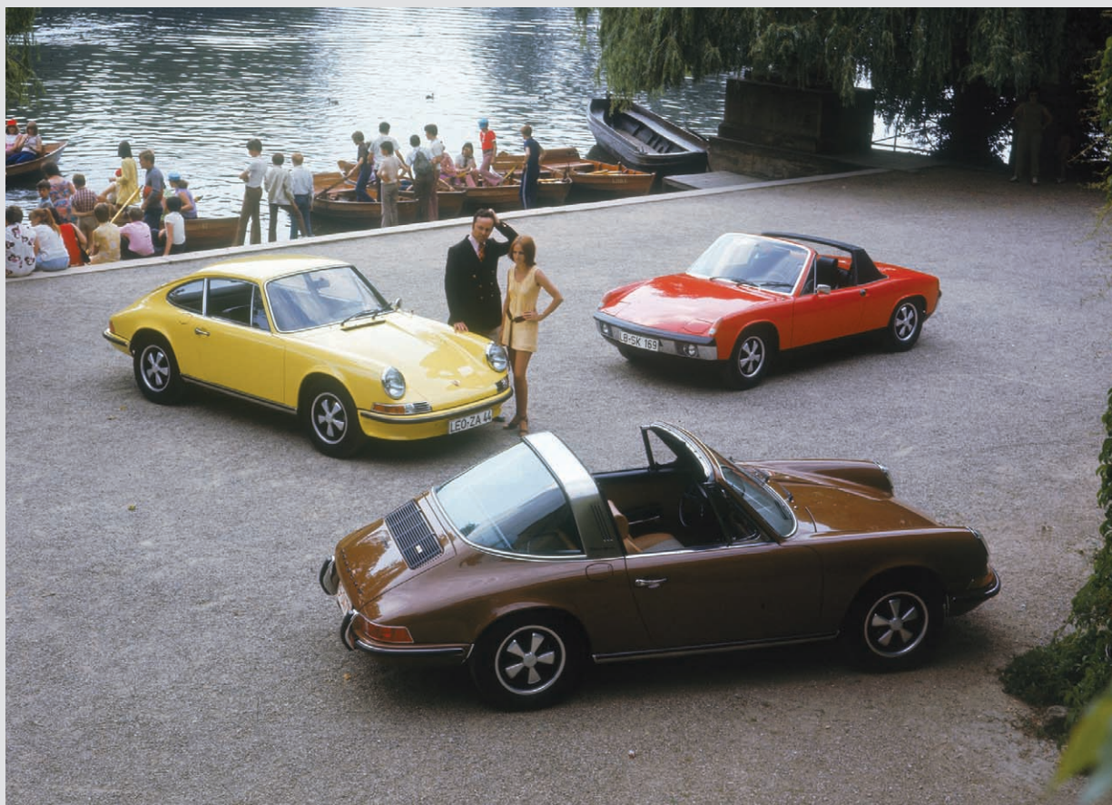
1972年型のタルガ（手前のモデル）、クーペ（左）、914（右）。この頃になると、外観からは見分けはつかないが、2.2リッターモデルから排気量をアップした2.4リッターモデルのホイールベースは3mm延長され、2271mmとされた
