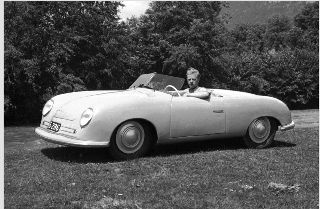
テスト中のポルシェ No.1（エンジンをミッドシップに搭載した唯一の356プロトタイプ）
