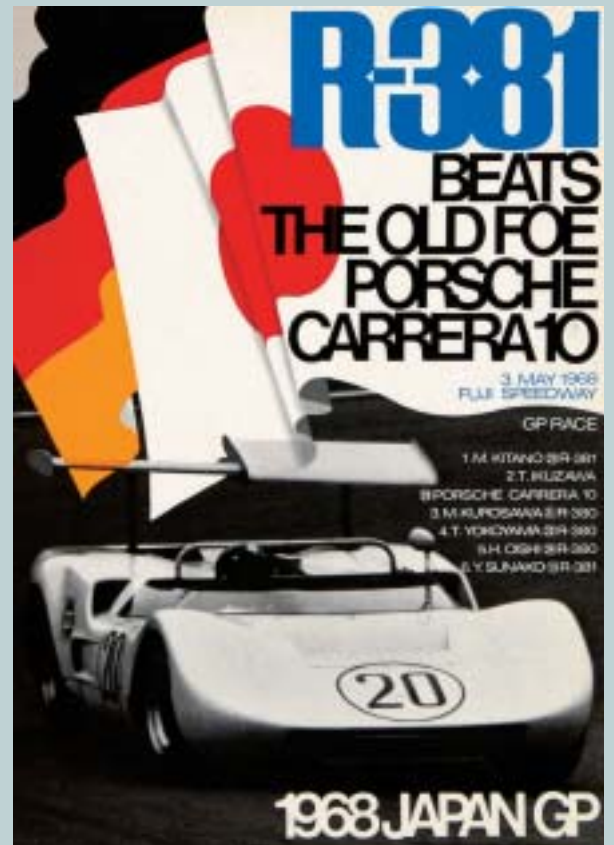
1968年5月3日、富士スピードウェイで開催された第5回日本GP優勝車R381。R381はアメリカのムーンスターエンジンのシボレー・エンジン、V8、OHV、546cc、400ps/6800rpm、545kg-m/5500rpmを積み、世界初の分離型エアロ・スタビライザーを備えていた。レースは80周、480kmで争われ、R381は1、6位。ボルシェ910が2位。そしてR380-III型が3、4、5位であった。
