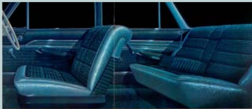
グロリア・デラックス(S40D-1型)の室内および運転席。インストルメントパネル、ステアリングホイールなどは、豪華なものになり、メーターユニットには我が国初の、プリント配線方式が採用された。フロントドアには、クランクハンドルで開閉できる、三角窓が装備された。我が国初の本格的エアコンディショナーがオプション設定された。
