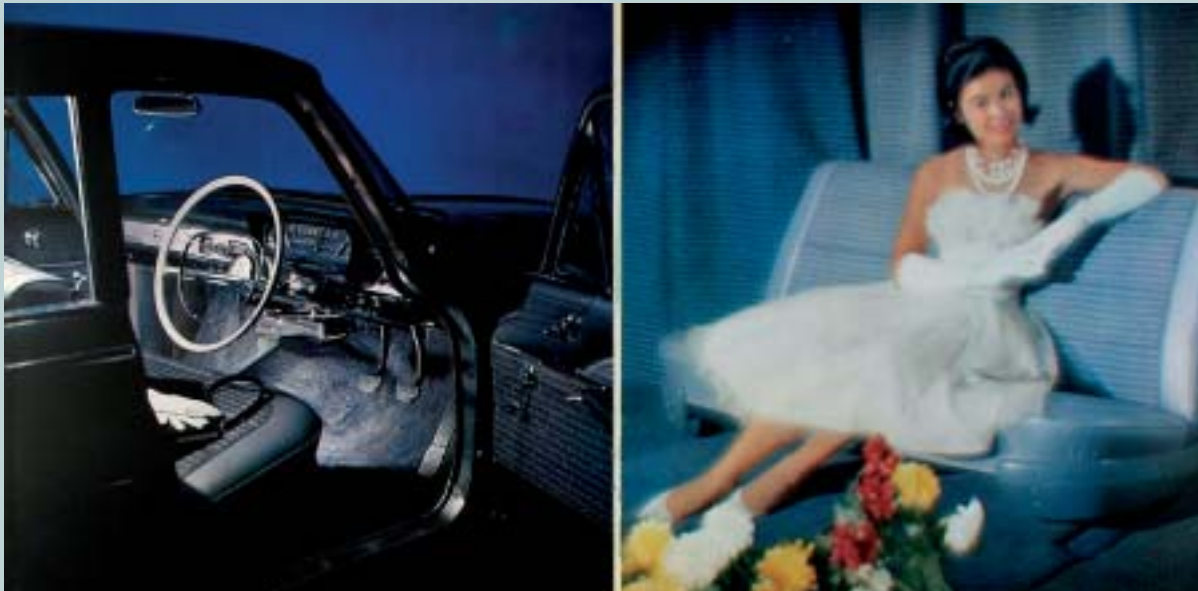
グロリア・デラックス(S40D-1型)の室内および運転席。インストルメントパネル、ステアリングホイールなどは、豪華なものになり、メーターユニットには我が国初の、プリント配線方式が採用された。フロントドアには、クランクハンドルで開閉できる、三角窓が装備された。我が国初の本格的エアコンディショナーがオプション設定された。
