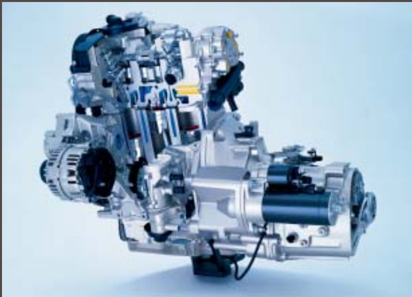
フォルクスワーゲン ポロ3L TDI ポロはゴルフの分岐型とも言えようが、新設計の3シリンダー直噴ターボ付きエンジンを搭載した3L TDIの3Lは3リッターカー、つまり100km/3リッター（33.3km/L）の燃費の標榜である。1998年、バリ・オートサロンでデビュー、ポッシュ製の小型ユニットインジェクターの登用は世界を驚かせた。エンジンはボア（シリンダー直径）×ストローク（行程）=76.5mm×86.4mmで、排気量1191cc、49kW（67PS）/4000rpm、CO 2 排出量、81g/km（本文参照）。
