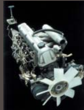
日産スカイライン 280D GT 日産は1964年にセドリックディーゼルを発売したが、1979年乗用車用として初めて6シリンダーディーゼルエンジンLD28型を開発、セドリックと共にグランドツーリングカー（長距離ドライブスポーツカー）にも搭載した（本文参照）。日産は1968年以降、ブルーバード、ローレル、チェリー、サニーそしてスカイラインとディーゼル車を充実させていた（写真左はグロリアに搭載されたLD28型エンジン）。
