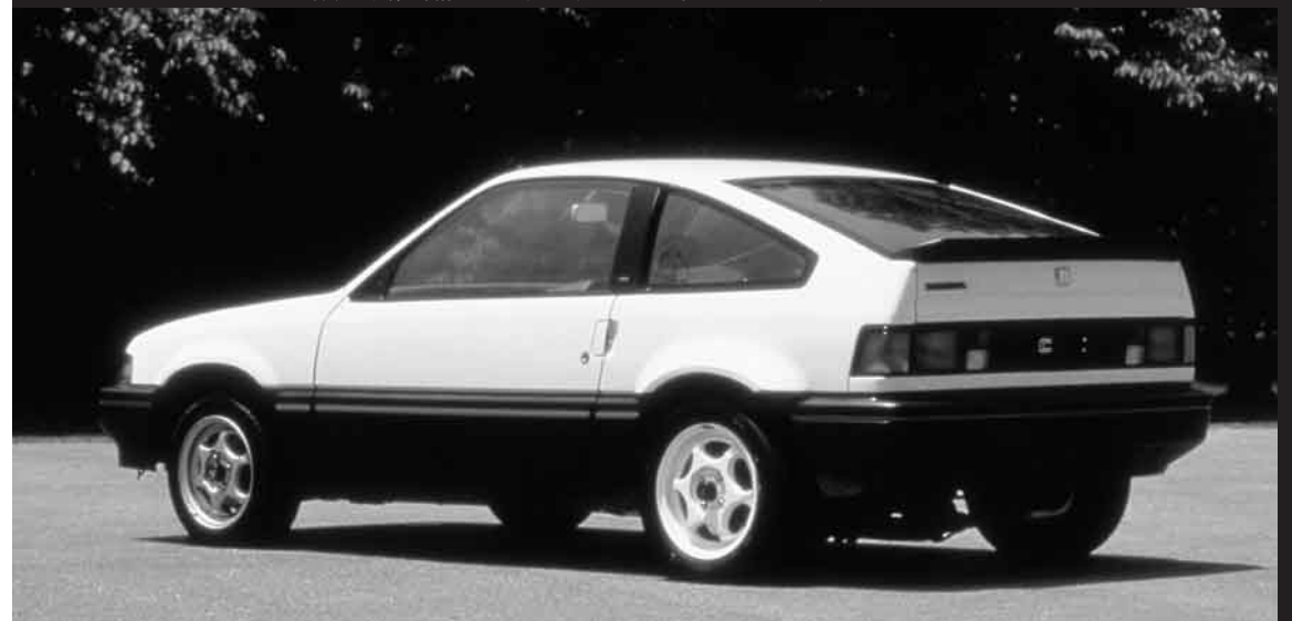
UMR研究はシティを経て、初代CR-Xへとベース車を変更する。当初は1ℓそこそこのエンジンを搭載していたが、スポーツカーの製作が決定されるとその排気量は2ℓまで拡大されることになる。写真下は実際に製作されたミッドシップCR-X。拡がったリヤトレッドに注目。
