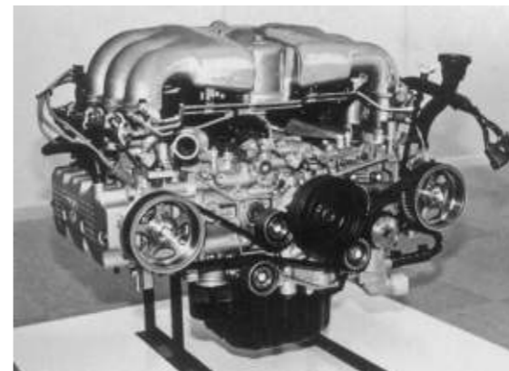
3リッターSOHC24バルブの試作エンジン。左右各1本のカムシャフトで1気筒あたり4バルブを駆動するバルブシステムを備えた、実用性重視のタイプである
