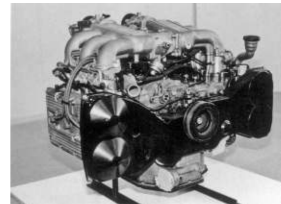
開発途中まで本命とされていた、3リッターDOHC24バルブの試作エンジン。エンド・ピボットタイプのロッカーアームによるバルブ駆動システムを備えた高回転、高出力タイプである
