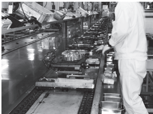
1：エンジン組み立てライン。クランクケースがラインに流れてくる ところ。
