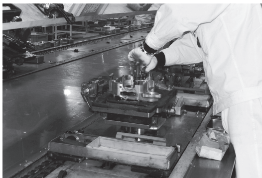
2：ギアの組み付けは手作業で行なわれる。ギア等の回転部分や可動部分の部品は、十分にエンジンオイルを塗布してから組み付けられる。
