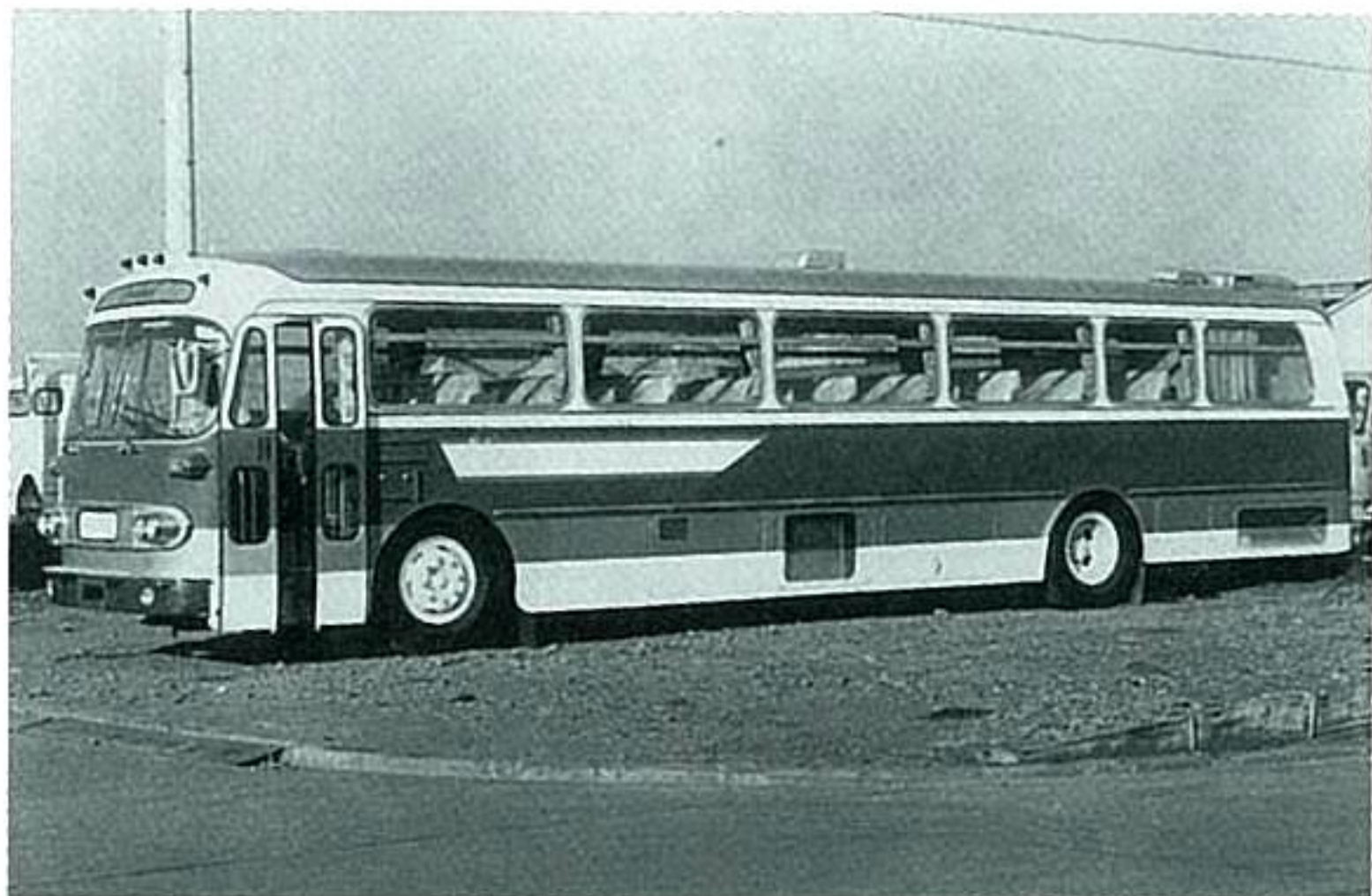
1969年 日野RA900-P型高速バスは350psの高出力で140km/hをマーク。(TS)
