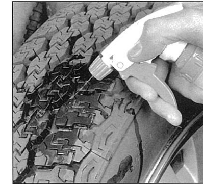
5.4b バルブコアが緩んでいないければ、ジャッキアップして、そのタイヤをゆっくりと回転させながら、トレッド面に石鹸水をスプレーしてみる。空気漏れがあれば泡が出るはずである
