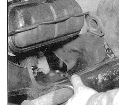
5.11 ヒートエクスチェンジャーをエンジンの上に位置決めする(写真は初期モデル)
