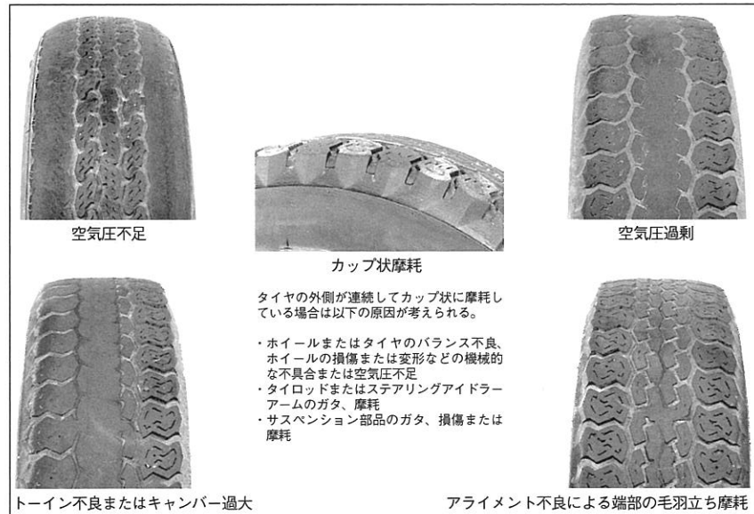
5.3 これらの写真を参考にして、タイヤの状態を判断するとともに、異常摩耗の原因を推定して必要に応じて修正する
