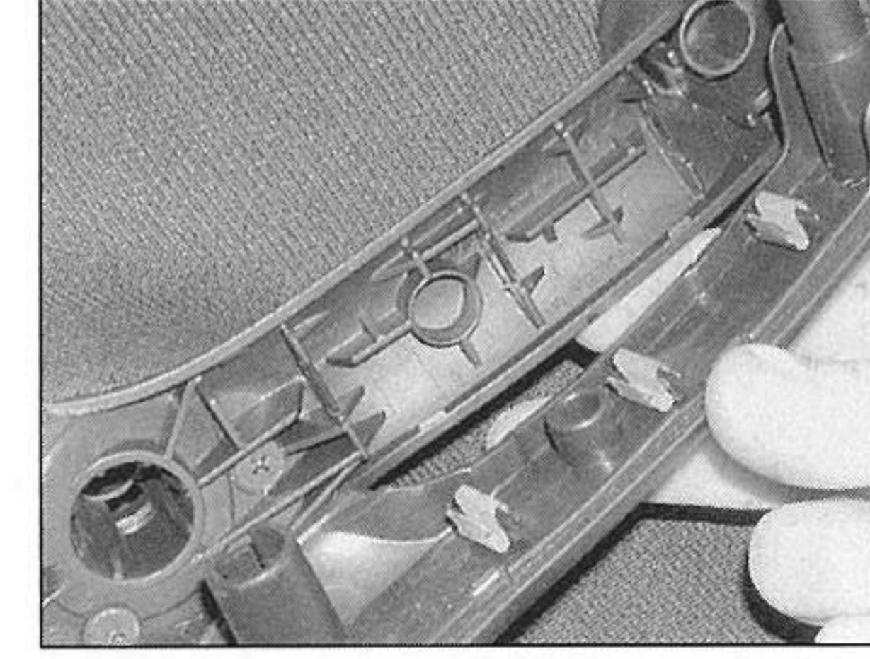
12.2 3個の固定クリップを慎重にこじって外して、トリムを取り外す
