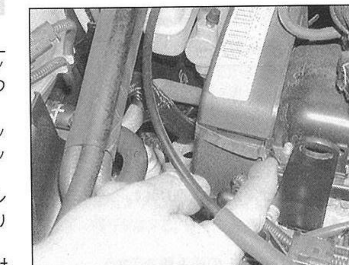
6.1a カバーの前後のクリップを外して...
