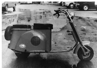
ラビット 富士産業(現・富士重工業)が製作した4ストローク単気筒、サイドバルブのスクーター。エンジンの始動方式はリフターを使った「押し掛け式」だった。
