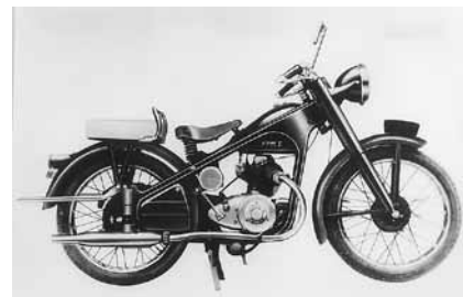
ホンダドリームE型(1951年) 空冷4ストローク単気筒146cc。D型(2ストローク)の排気音が気に入らず、4ストロークOHVにしたモデル。設計者の河島喜好が自ら運転し、箱根の峠越えテストをやり遂げたという。
