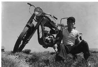
ホンダドリームD型(1950年) 空冷2ストローク単気筒98ccで5000回転時3馬力を発生。それまでエンジンのみを製作していたホンダだったが、初めて自社製フレームを使用したモデル。マシンを囲み「夢のようだ」と皆で感動したままを車名にしたという。
