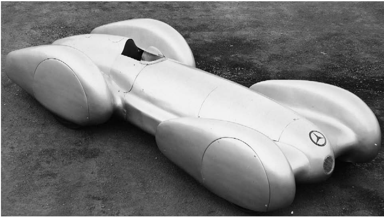
1939 年レコルトワーゲン。W154 グランプリカーに、Cd=0.184 まで空気抵抗が低減された特製の空力ボディを載せた速度記録車。M163 型 483 馬力 /7800rpm エンジンを積む。
