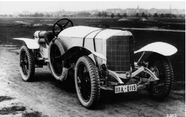
1921 年メルセデス 28 / 95 馬力型。SOHC6 気筒 7.27ℓ (105×140mm) 95 馬力 / 1800rpm フロントブレーキが装着されているのに注意。マックス・ザイラーが 1921 年のタルガ・フロリーオで総合 2 位を獲得した。
