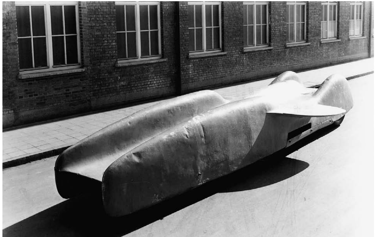
ボディの空力デザインを担当したのは、フォン・ハフゼンフェルト。超高速域で車体を地面に押さえつけて安定させる為のウィングが左右に張り出している。
