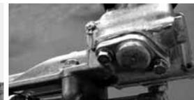
シフトレバーはセレクト方向に左右 25.0mm 動くが、その 25.0mm に +10.0 mm、こちら側に動く。その動きを可能にするためにスプリングが挿入されている。ここまではシフト操作に拘っていたのだ。
