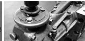
チェンジコントロールケース内には、75W-90 のオイルが 80 ~ 95cc 入る。これは「2 段入り」防止のため。この粘度は静・動摩擦係数をチューニングした新開発のオイルだった。この個体はダストブーツが破れている …。
