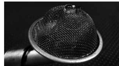
オイルストレーナーの網の上に乗っているのは金属が削り取られた大きな破片。薄い板状に削り取られているが、これはエンジン内部の摺動部から削り取られたものであることに間違いはない。これが、再びエンジン内部へと還流していったら、ダメージは想像以上に大きなものになっていたはず。エンジン内部は金属同士が摺動する部位は多いのだ。その意味でもオイル交換の大切さと潤滑の重要性を思い知らされる。
