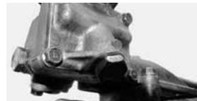
チェンジコントロールケースを下側から見る。こちらのボルトはチェンジレバーのスプリングシートをしっかりと固定するため。固定は左右と後部から行なわれていて、すべてに銅ワッシャーが入る。
