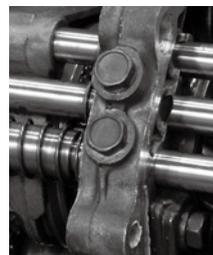
ベアリングユニットに設けられたシフトロッドスプリングを固定するボルト。シフトロッドスプリングはギャップと接触するベアリングを押し、シフトロッド上の凸がスプリングを押し返すことで、シフトの節度感を作り出す(左)。右はそのパーツだ。
