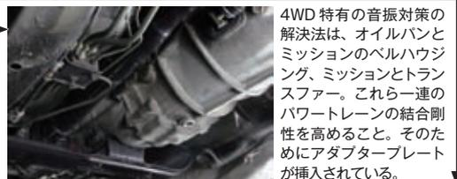
4WD 特有の音振対策の解決法は、オイルパンとミッションのベルハウジング、ミッションとトランスファー。これら一連のパワートレインの結合剛性を高めること。そのためにアダプタープレートが挿入されている。
