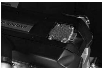
バワトラユニットにはECCSからの点火信号をもとにイグニッションコイルの一次側への通電を行なう。ここまでは全て低電圧だ。
