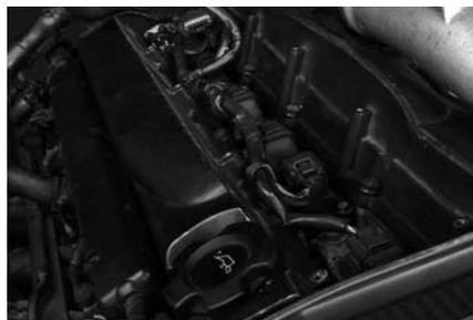
コイルに配線が挿入されているカプラー部分は樹脂製。20 年も経っているから仕方がないが、熱による劣化でツメが折れてしまうという。
