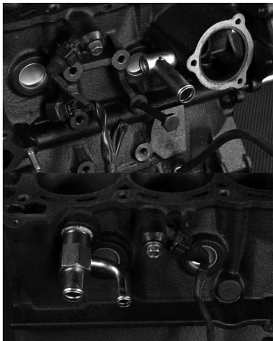
ターボ過給により燃焼温度が、約1000℃にもなるためノッキングには細心の注意が払われている。そのひとつの表れがこのノックセンサー。ターボが2つあるようにノックセンサーも2つある…。ノックセンサーは通常とはわずかに違う振動(4~7kHz)を電圧素子で感知するものだが、それを2つ装着したところに燃焼温度管理への気遣いが伺われる。
