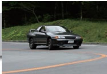
前輪の舵角が足りないようでステアを切り足す。ここでの感触は若干のアンダーステア。まだ完全にヨーレートが立ち上がっていないうえに、フロントタイヤのCPの立ち上がりもまだ完全な状態ではないように感じる。
