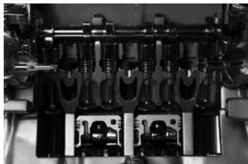
インテーク側の動弁機構の跳め。オイルジェットからのオイルの入口と出口、各シリンダーヘッドを冷却する水路もよく分かる。
