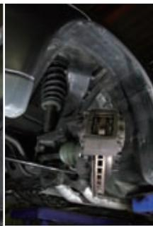
これは進行方向左側のサスペンションを前方から撮ったもの。サードリンクのダンパーのロア支持点の取り方はやはり発想の勝利だ。そのロア支持ブラケットからスタビライザーのリンクが伸びる。確かに複雑怪奇で重いアームだが、このサードリンクはジオメトリーに関して設計上の自由度が増えるという点で時代をリードしたサスペンションだった。ちなみに、CV ジョイントの保護ブーツは車外品だが、整備性に優れた二分割タイプに交換されている。
