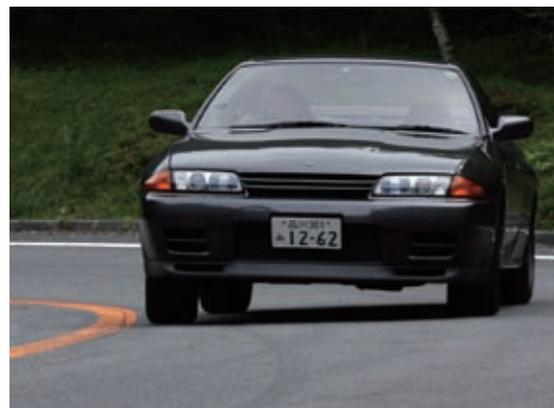
スライドも治まり加速状態へ。この状態では横Gに対する挙動とヨーレートの世界から、前後のトラクション重視の世界へと移行していく。トルクの前後配分が加速にもよるが、0:100～30:70の範囲での配分だ。280psが無駄なく路面へと伝えられていく。
