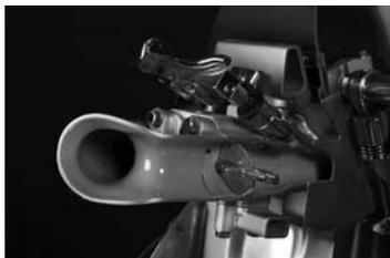
燃料インジェクターの容量は静的噴射量が444cc/min。燃圧は2.55kg/cm<sup>2</sup>だ。奥にいくに従って絞り込まれている様子がよく分かる。
