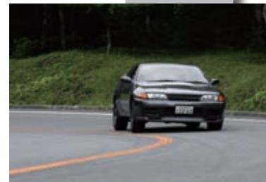
この状態がATTESA E-TSの真骨頂。わずかにフロントにトルクが流れることにより車両の挙動が安定してくるのだ。フロント左タイヤがさらにサチュレートしているのが分かるが、4輪がきれいに流れ続けているので気にならない。
