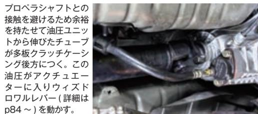
プロペラシャフトとの接触を避けるため余裕を持たせて油圧ユニットから伸びたチューブが多板クラッチケーシング後方につく。この油圧がアクチュエーターに入りウィンドロワフルレバー（詳細は p84 ~）を動かす。
