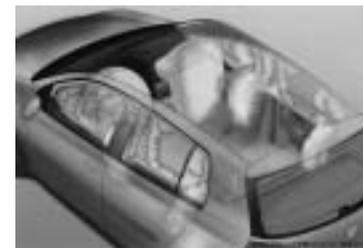
運転席/助手席のエアバックに側面衝突に対するサイドエアバックを前後に装備。加えて側面衝突を感知すると全体を覆うように展開するカーテンエアバックを採用する。合計8個のエアバックを標準装備して高い安全性を誇る。
