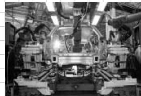
ボディのレーザー溶接による接合部は、新型では70mmにも伸ばされた。その結果、静的ねじれ剛性は80%以上も向上し、ハンドリングなどの走りの性能に加え、乗り心地や静粛性なども大幅に向上されている。
