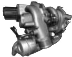
エンジンが3500回転を超える回転域では、スーパーチャージャーは電磁クラッチによって完全に停止状態になり、必要な過給圧はターボによって供給される。
