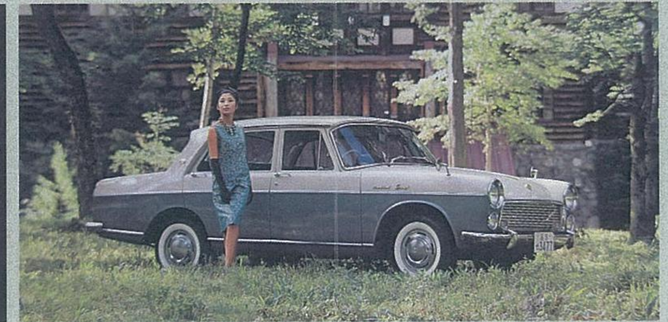
軽く、強く、広いボディ構造。これがベレルに採用されているユニタリーコンストラクション（単体構造）ボディです。構造力学的にも入念に計算されたこのボディ構造は、走行性能に大きく影響する軽量、外部からの衝撃に対する充分な剛性と安全性、広くとれる空間処理などを、安全にまもっています。
