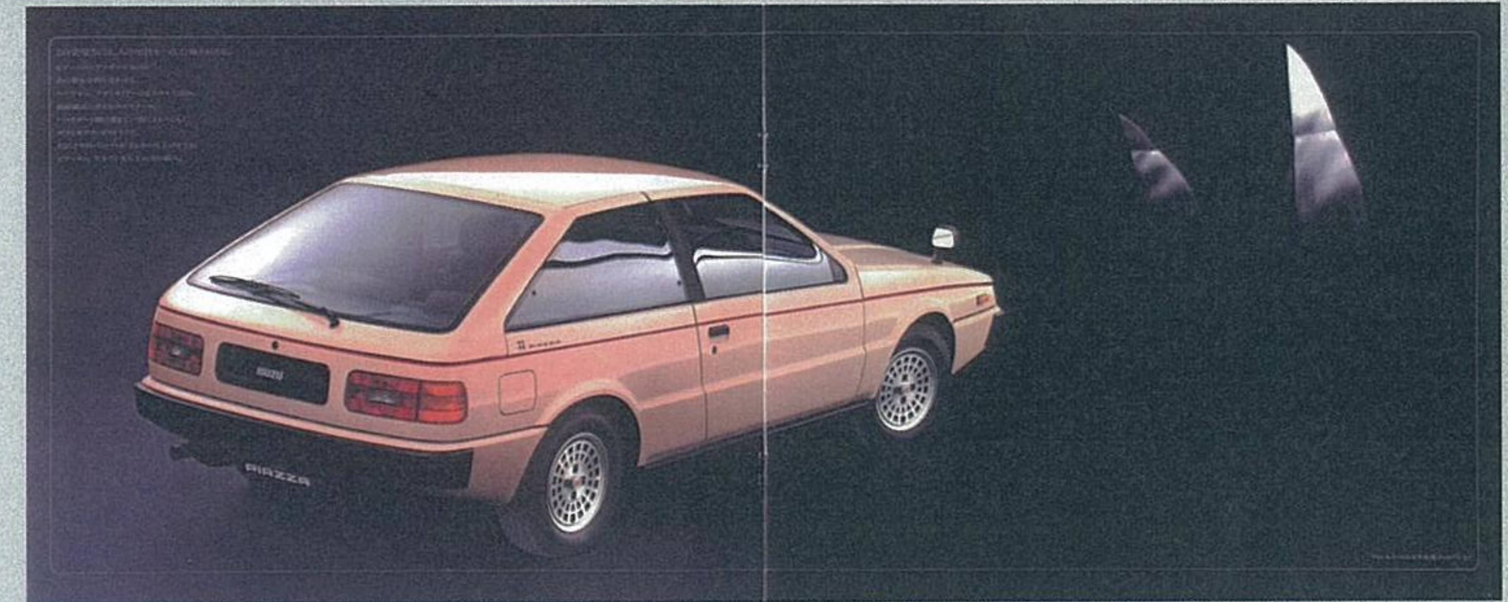
ピアッツァXFモデルの後ろ姿。ボディパネルとガラス面、テールランプ類の凹凸が無い徹底したフラッシュサーフェスであることが分かる。写真のアルミホイールはXEには標準設定されていたが、他のグレードではオプションであった。
